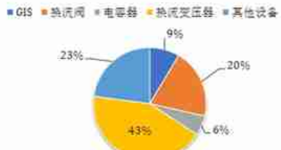
图 36: 特高压项目设备价值量占比
