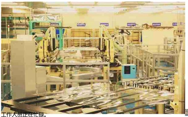
2月1日,安徽合肥新站高新区的彩虹(合肥)液晶玻璃有限公司智能工厂内,G8.5+ 大吨位高世代液晶基板玻璃生产线有序运转,自动化设备精准地完成玻璃基板的传 输、加工、检测等生产全过程,这些产品终端应用在液晶电视、智能手机、车载显 示屏等领域。
