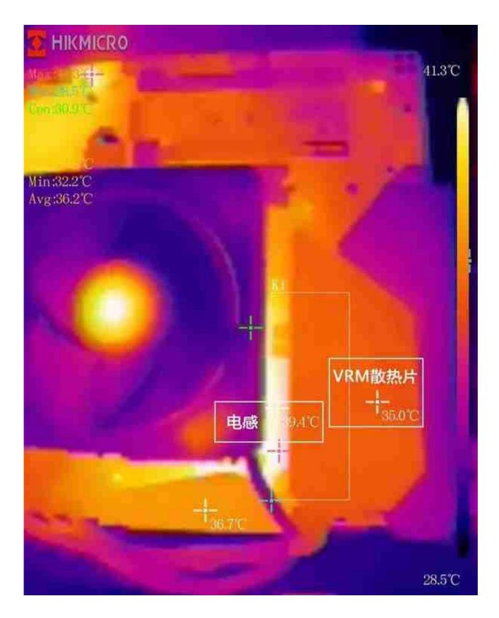
前面我们介绍过,雪雕B550M不但提供了10+2相数字供电,还配备了厚实的延展式VRM散热片,充分保障了处理器满载工作时供电电路不至于过热,那么实测情况如何呢?我们使用AIDA 64进行FPU考机,AMD锐龙7 5700G满载考机功耗大约在70W左右,最终雪雕B550M的MOS管温度传感器报告仅有33℃,用海康微影P10
