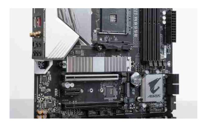
散热方面,雪雕B550M不但在VRM部分加装了厚实的延展式散热片,还为第一条M.2插槽提供了散热装甲,确保长时间工作不会过热。
