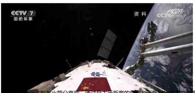
大方人。最远飞船与火箭分离后,通过自主远距离的导引和近距离的自主控制两种方式,从200公里的近地轨道运行到393公里的空间站轨道上,从而实现快速交会对接。
