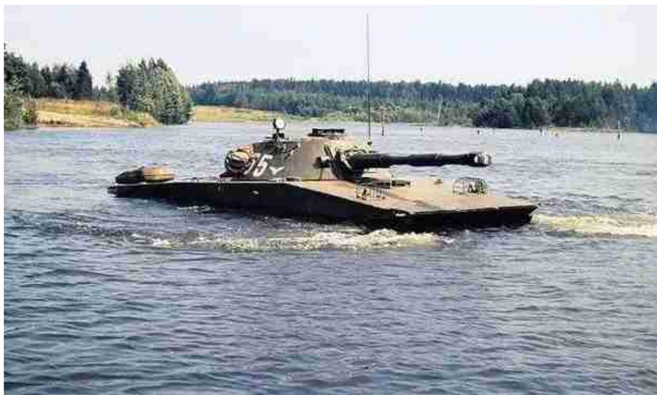
63式坦克的战斗全重为18.4吨，采用排水型车体设计，乘员4人。陆地行进是靠履带（6对负重轮），“飙车”时速可达64.2km/h；水上行进靠喷水（车内装有一套轴流式喷水推进器），最大航速11-12km/h，能抗3级风、4级浪。1966年时还做过“横渡琼州海峡”的试验。
