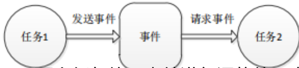
图 41.1.1 两个任务使用事件进行通信的示意图
