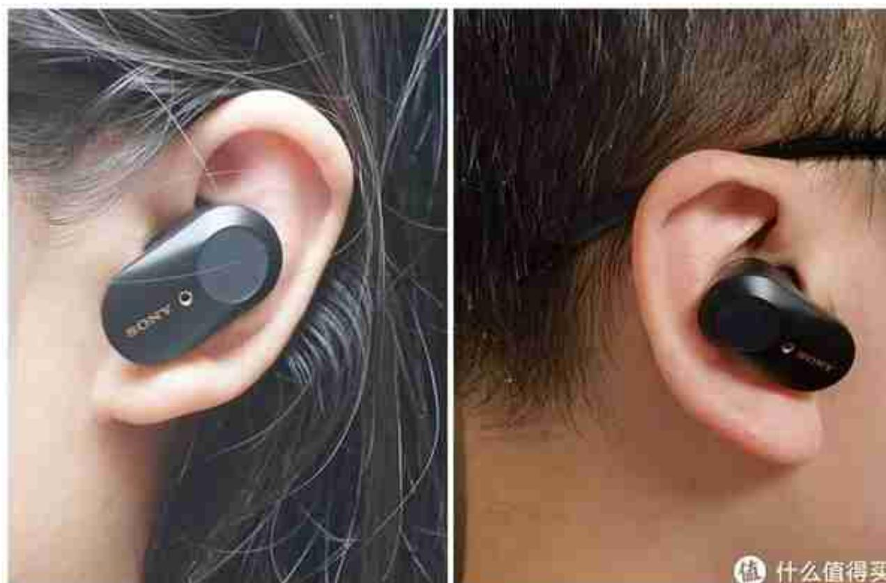
WF-1000XM3没有额外的耳廓挂架，完全依靠三点结构和耳机的橡胶摩擦来固定，所以耳机的最稳固佩戴角度是耳机的尖端朝向前下方，也就是指向嘴的方面，这个角度是最不容易脱落的。
