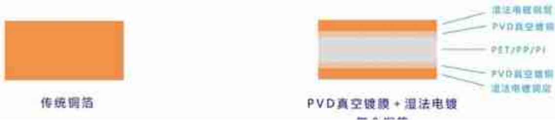
铜箔/复合铜箔断层示意图
