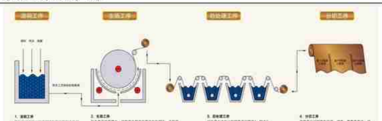
图表 32 电解铜箔生产工序
