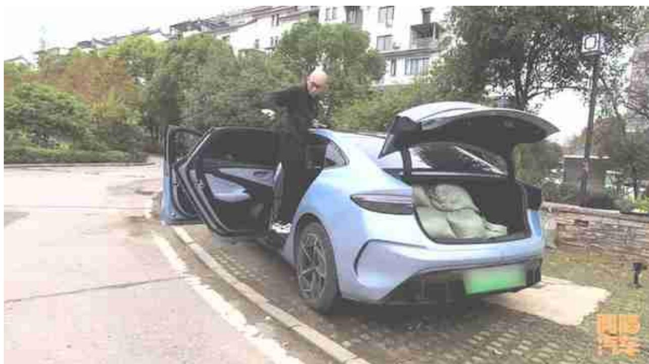
我们可以通过车身的4门2盖是检测出来，在测试前，我先在平地上记录下海豹的四门，尾箱门开合情况和缝隙。
