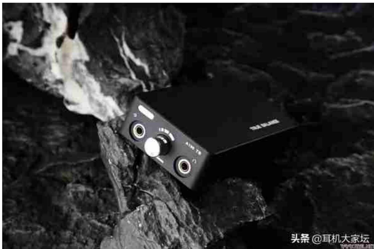
A100 TB，是A100的全面升级版，同时它更为专一极致。在 A100的经验后，A100TB重点放在保留特点的同时，对内部电路进行一次完全革新，并且选择了只支持4.4mm平衡输入和输出。
