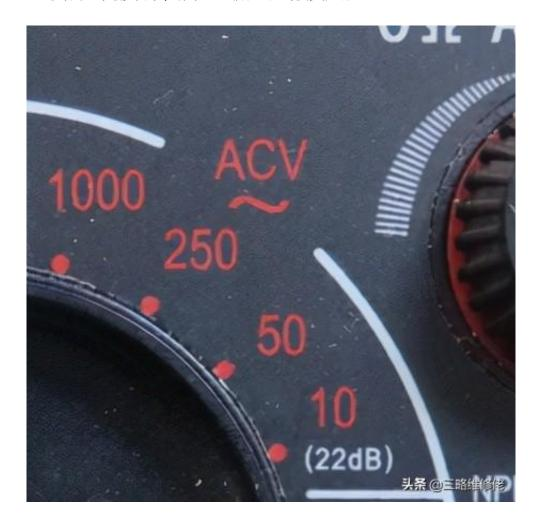
根据万用表使用特性,所选电压量程必须高于被测电压量程,否则,电表就会烧坏,测量交流电压时要与被测电源并联。
