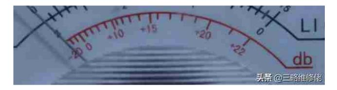
测试分贝时在表棒串接一个0.047微法耐压400伏的电解电容,然后读取分贝标度尺刻度线的读数,
