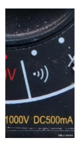
将量程开关置于音频符号挡位,如果被测电路或者器件的电阻值小于200欧姆时, 蜂鸣器就发出鸣叫,鸣叫就是通,无声表示不通。
