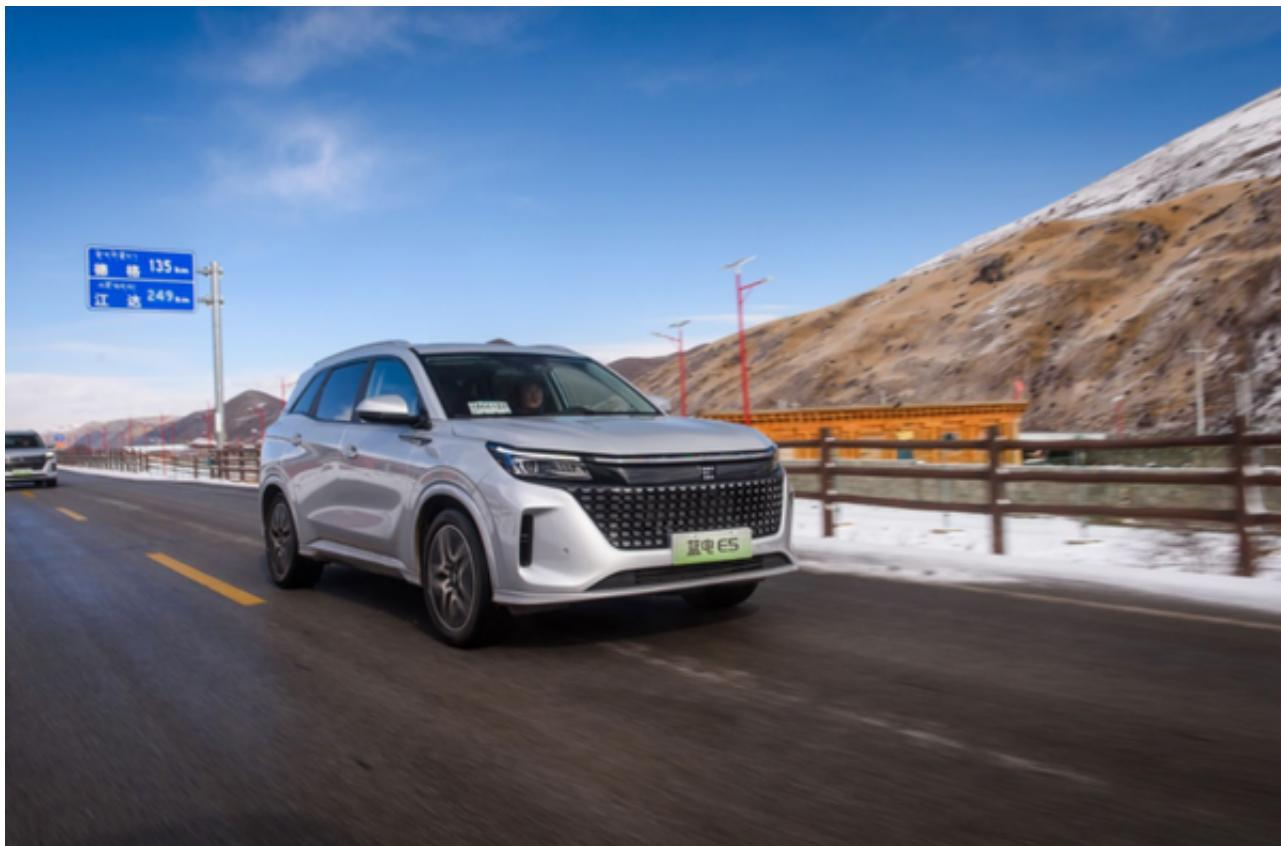
同时，蓝电E5搭载弗迪动力出品的1.5L高效插混专用发动机和DHT300电混系统，有最高热效率高达43.04%，最高传动效率97.5%的表现。成熟的弗迪混动系统，优势在于电动优先、电驱为主，可让蓝电E5实现全工况电驱占比超80%、市区工况电驱占比99%。在充电方便的城区，完全可以采用纯电模式，无焦虑地享受纯电动汽车的美好；在常温常用工况下，蓝电E5带来发动机无感启停、无感直驱、平顺丝滑的驾驶感受，平衡了能耗、保电、NVH、加速等多种因素，为用户提供电动驾享体验。
