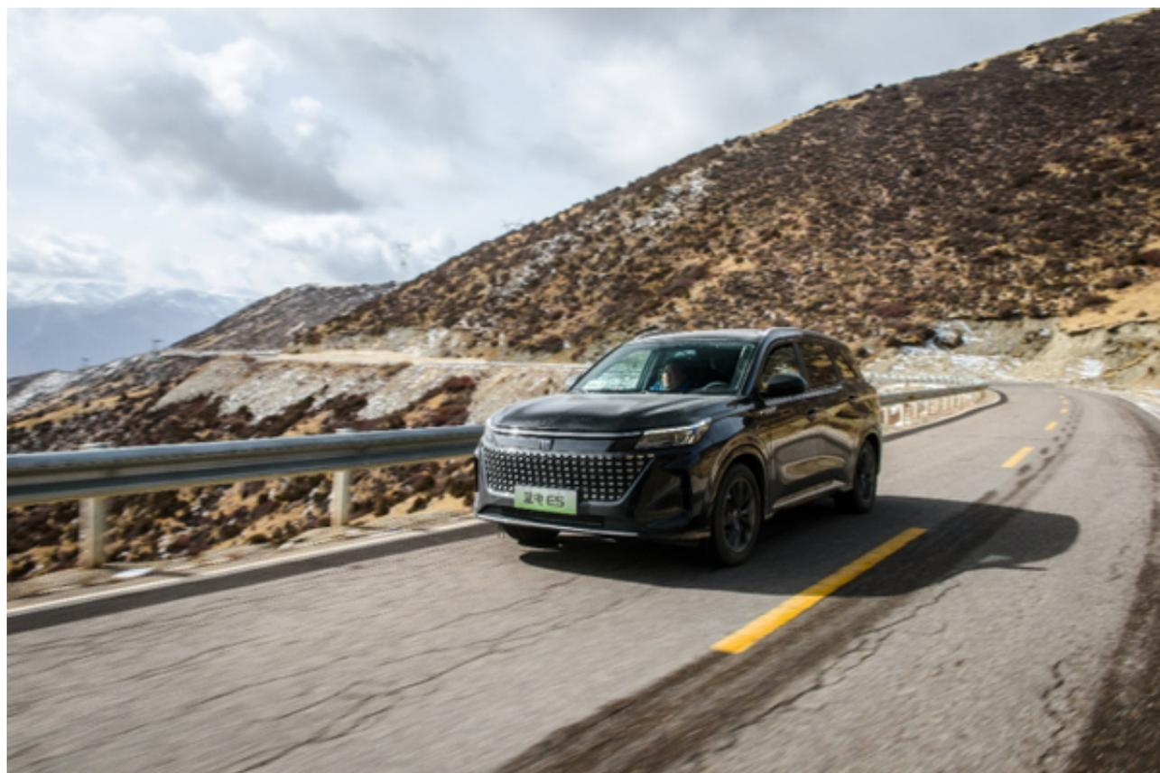
长安欧尚Z6 iDD搭载的是1.5T发动机和电动机的组合，它的发动机最大输出功率为170马力，最大扭矩为260牛·米；电动机最大输出功率为150马力，最大扭矩为330
