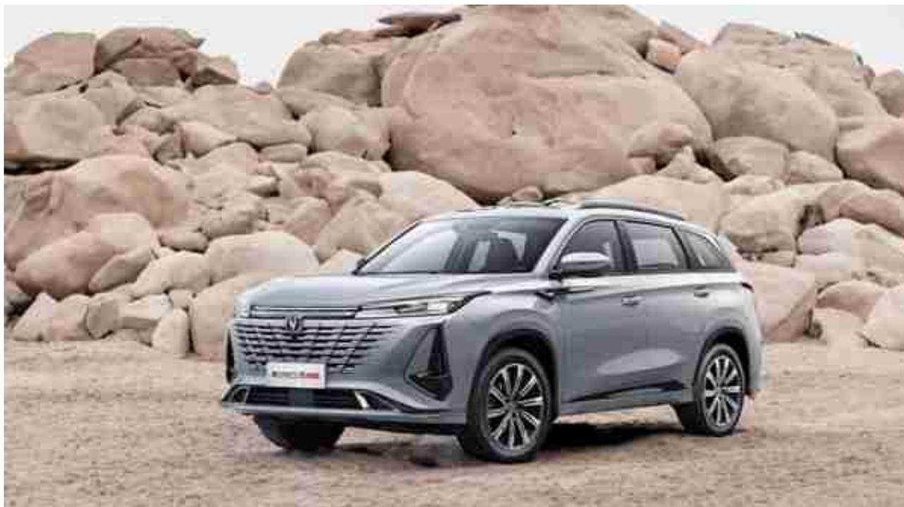
据悉，第三代长安CS75 PLUS的长宽高分别为4710mm/1865mm/1710mm，轴距为2710mm。它的定位是紧凑型SUV，本来车内的空间就要比蓝电E5短一截，同时仅仅只有五座的布局形式，空间表现自然处于劣势。
