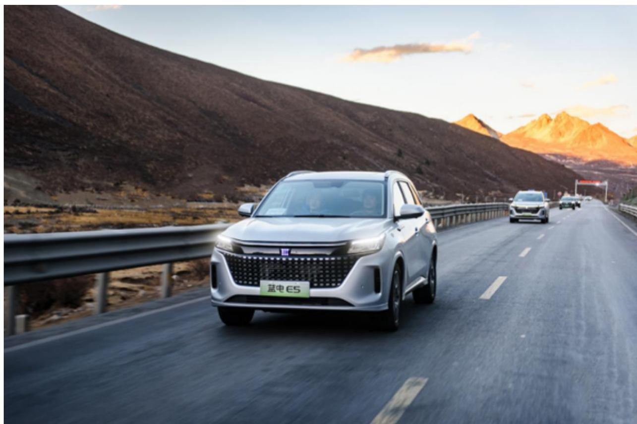
蓝电E5搭载比亚迪旗下弗迪动力的1.5L插混专用发动机和DHT300电混系统，假如平时只用油行驶，WLTC百公里馈电油耗仅5.5L。0-100km/h加速7.4秒。蓝电E5的动力输出十分平顺，发动机介入时，体感上也并不会察觉得到。另外，这套动力系统已经应用在了比亚迪旗下多款插电混动车型上，早已得到了市场的验证，并且获得了消费者的深度好评。
