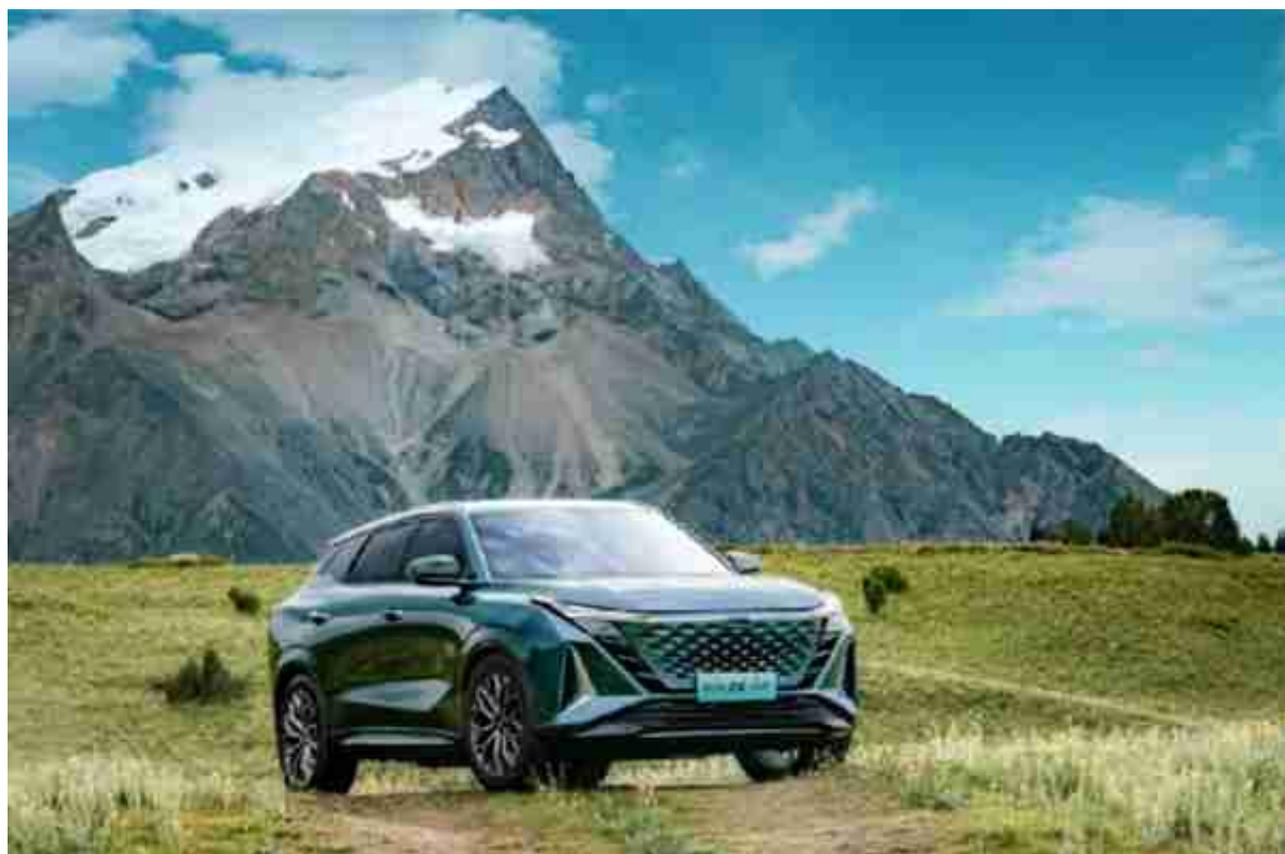
欧尚Z6智电iDD采用二合一电机+6速电驱结构，由一台最大功率125kW，最大扭矩260N·m的混动专用1.5T发动机和二合一电机组成，与之匹配的是6挡三离合电驱变速器。百公里馈电油耗5.7L，0-100km/h加速7.4秒。虽然欧尚Z6的加速与蓝电E5一致，但蓝电E5的馈电油耗和电车驾享还是要略胜一筹，毕竟弗迪混动技术的深厚底蕴和领先性摆在那里，后来者很难轻易超越。
