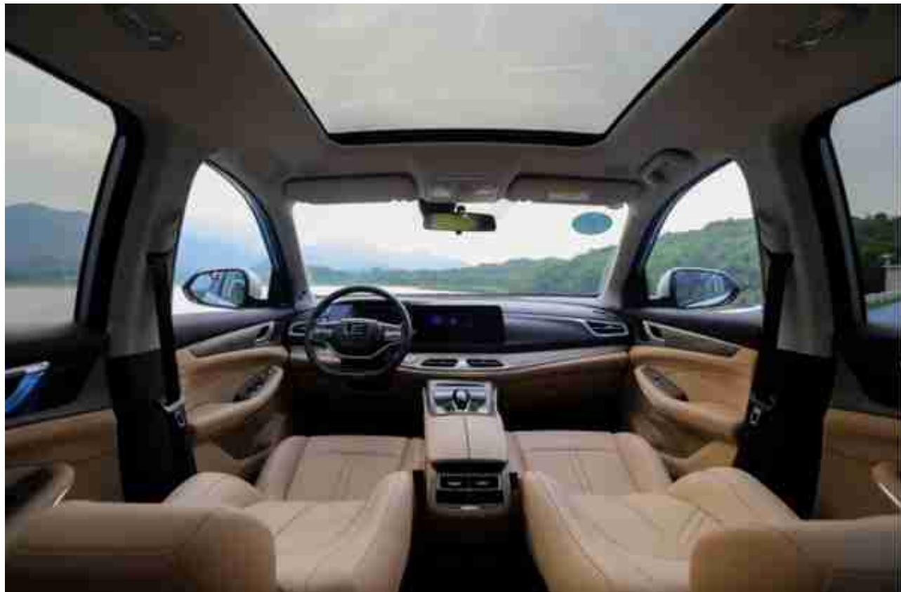
得益于2785mm的轴距，蓝电E5车内的空间也是非常宽敞的，新车提供5座和7座两种座椅布局。前排座椅支持165°后仰，后排灵活放倒后可实现不同的装载空间组合，第二、三排座椅全部放倒后，可以秒变“大床房”，再配合最大支持3.3kW外放电的V2L功能，完全可以满足家庭旅行和露营过夜需求。
