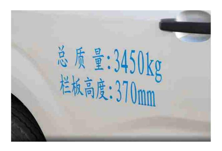
再看一下货箱数据,东风小康D71的货箱长度为3400mm,配合370mm货箱高度,最大载重质量将达到1775kg,这对于货运行业来说可太关键了,多拉多得这个道理还用解释吗?同时轴距越大、轮距越宽,还可以令空载或满载时的车身更平稳,自然有效提升安全性,让其能适应更多用车场景。值得一提的是,与强大的装载能力相匹配,东风小康D71全系标配双后轮+轻卡式直通大梁,这也确保了用户行驶中的稳定性和安全感,就算是货箱全部装满货物也能够稳重前行,再多的货也都能装得下、拉得动、跑的稳。
