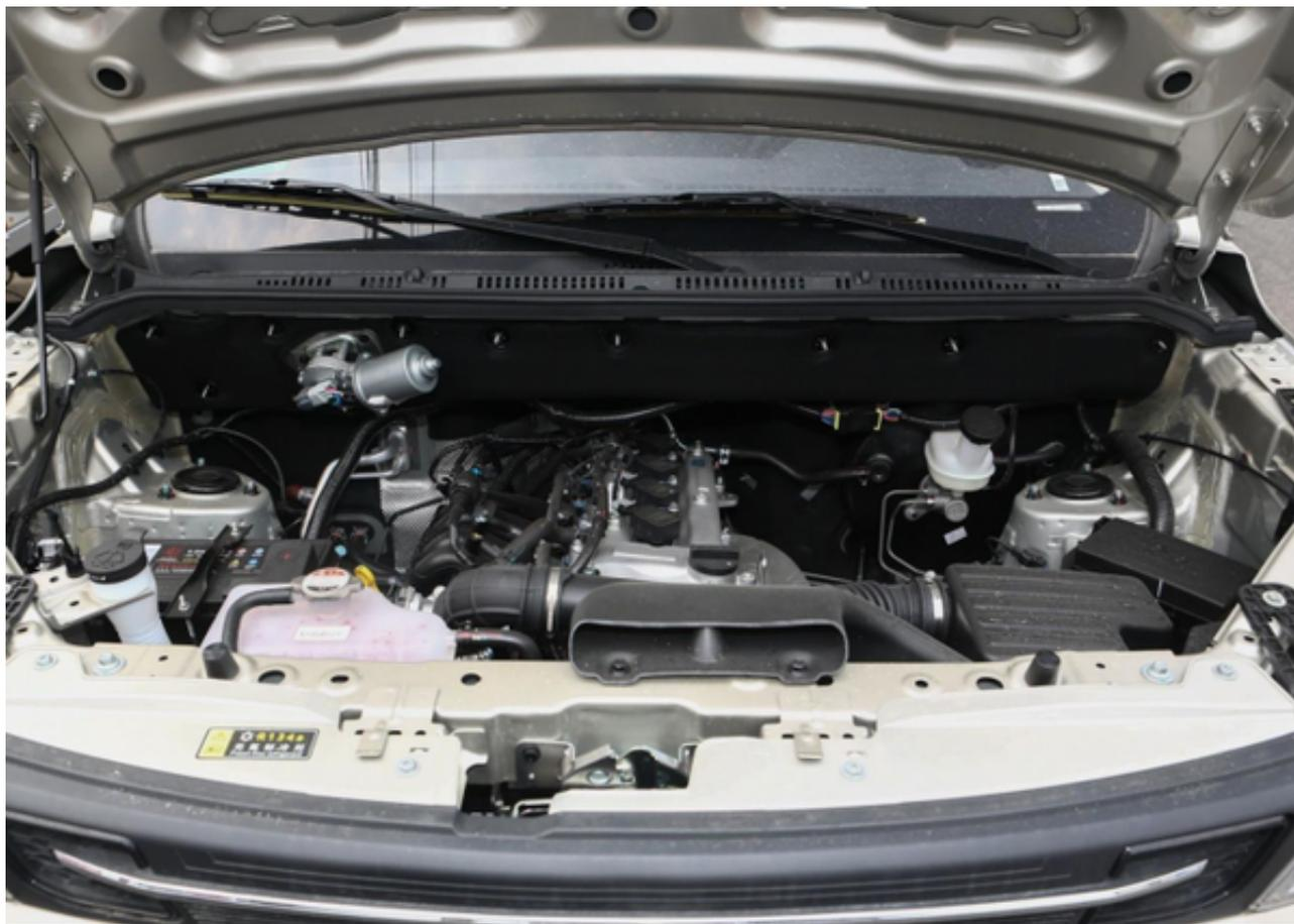
风光380提供1.5L动力系统，匹配5速手动，1.5L发动机最大功率112马力，峰值扭矩147牛·米，悬架系统采用前麦弗逊式、后钢板弹簧非独立悬架，匹配后轮驱动模式，底盘结构稳固，提升了行车的安全性。
