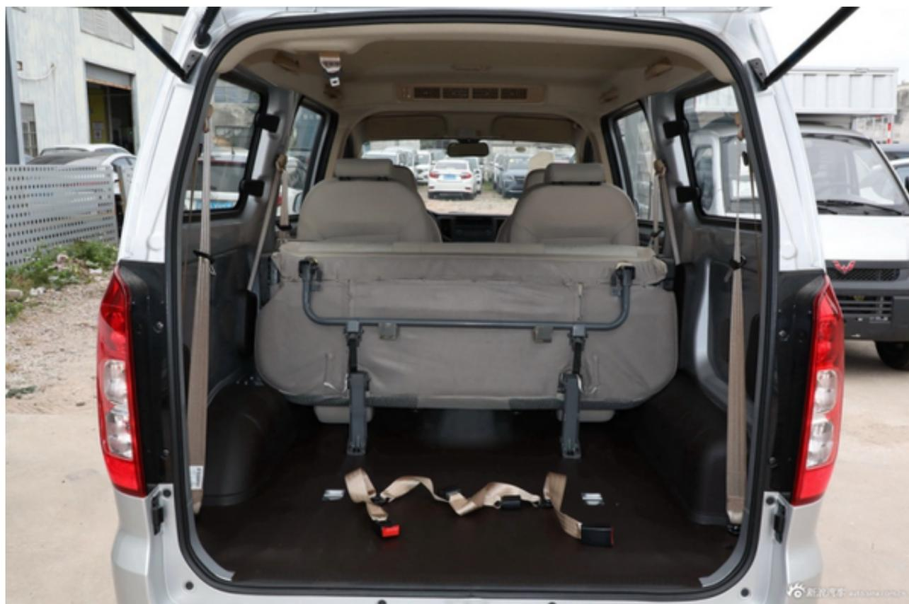
五菱宏光V的长宽高分别为4425/1670/1860mm，轴距为2850mm。同样提供两座，五座，七座和八座等多种座椅布局，后排也可以放倒和拆卸，但由于长度和宽度不及风光380，所以空间表现稍逊一筹。
