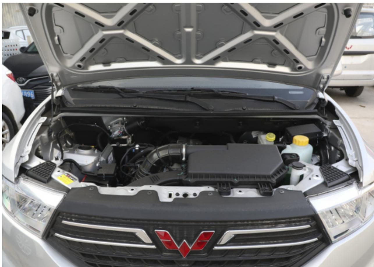
五菱宏光V提供1.2L和1.5L两款动力，分别匹配5速手动和6速手动变速箱，其中1.2L发动机最大功率76马力，峰值扭矩110牛·米，1.5L发动机最大功率99马力，峰值扭矩140牛·米，同样采用前麦弗逊式、后钢板弹簧非独立悬架系统。
