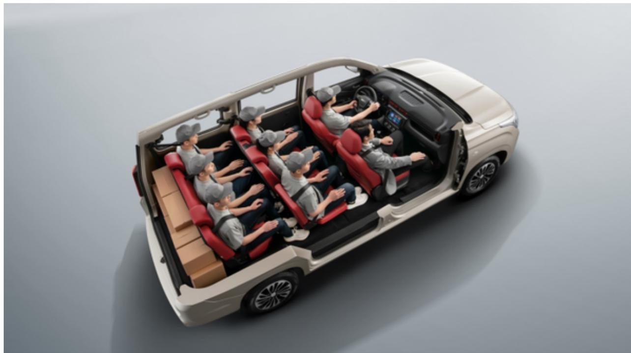
空间方面，风光380的长宽高分别为4610/1750/1860mm，轴距为2850mm，打造出最大可达5m<sup>3</sup>的装载空间。并提供两座，五座，七座和八座等多种座椅布局，并且后排座椅能够放倒和拆卸，就算载满三排8人，还能装载多达10个20寸拉杆箱，灵活性和实用性绝对是风光380的优势所在。
