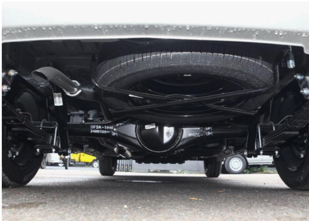
另外，风光380采用了前麦弗逊式独立悬架、后钢板弹簧非独立悬架系统，匹配后轮驱动模式，让车辆的底盘结构十分稳固，提升了行车的安全性。
