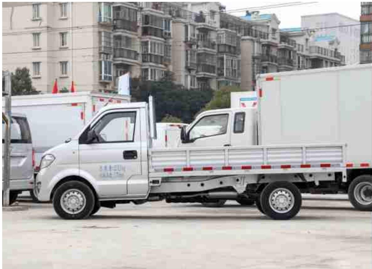
接着来看载物空间，东风小康C31S的货箱长宽高分别为3050\*1600\*370mm，最大载重质量为1035kg。如果按照载货时货物堆高1.6米来计算，东风小康C31S的货箱载货容积为7.81m<sup>3</sup>。
