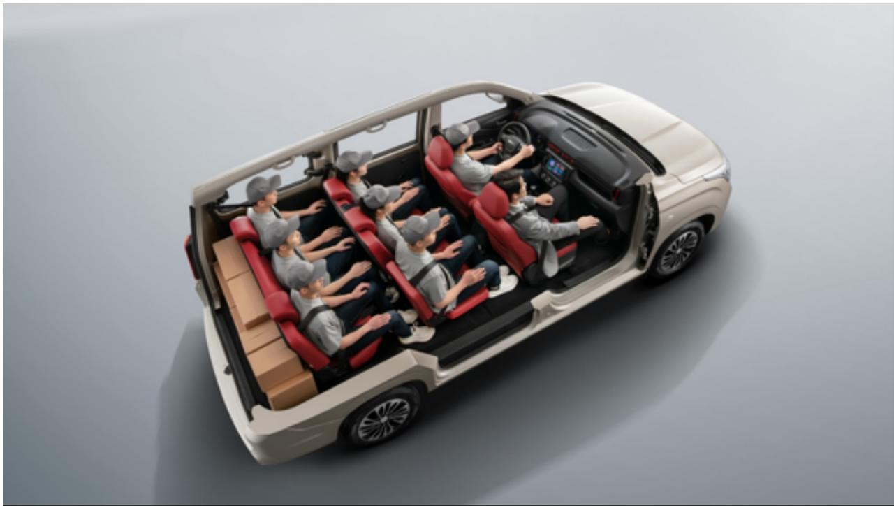
空间方面，风光380的长宽高分别为4610/1750/1860mm，轴距为2850mm，打造出最大可达5m<sup>3</sup>的装载空间。并提供两座，五座，七座和八座等多种座椅布局，并且后排座椅能够放倒和拆卸，就算载满三排8人，还能装载多达10个20寸拉杆箱，灵活性和实用性绝对是风光380的优势所在。
