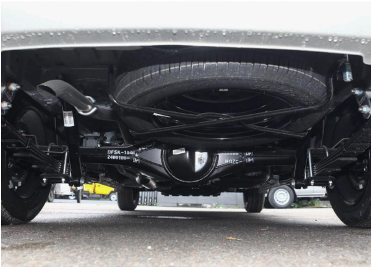
另外，风格380采用了前麦弗逊式独立悬架、后钢板弹簧非独立悬架系统，匹配后轮驱动模式，让车辆的底盘结构十分稳固，提升了行车的安全性。
