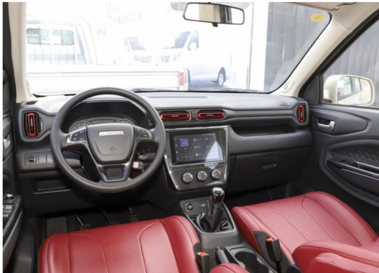
风光380的内饰设计简洁实用为主，仪表盘采用机械指针+液晶屏的组合，整个中控台的设计层次感不错，副驾驶前方设计了储物槽，提升了空间利用率。
