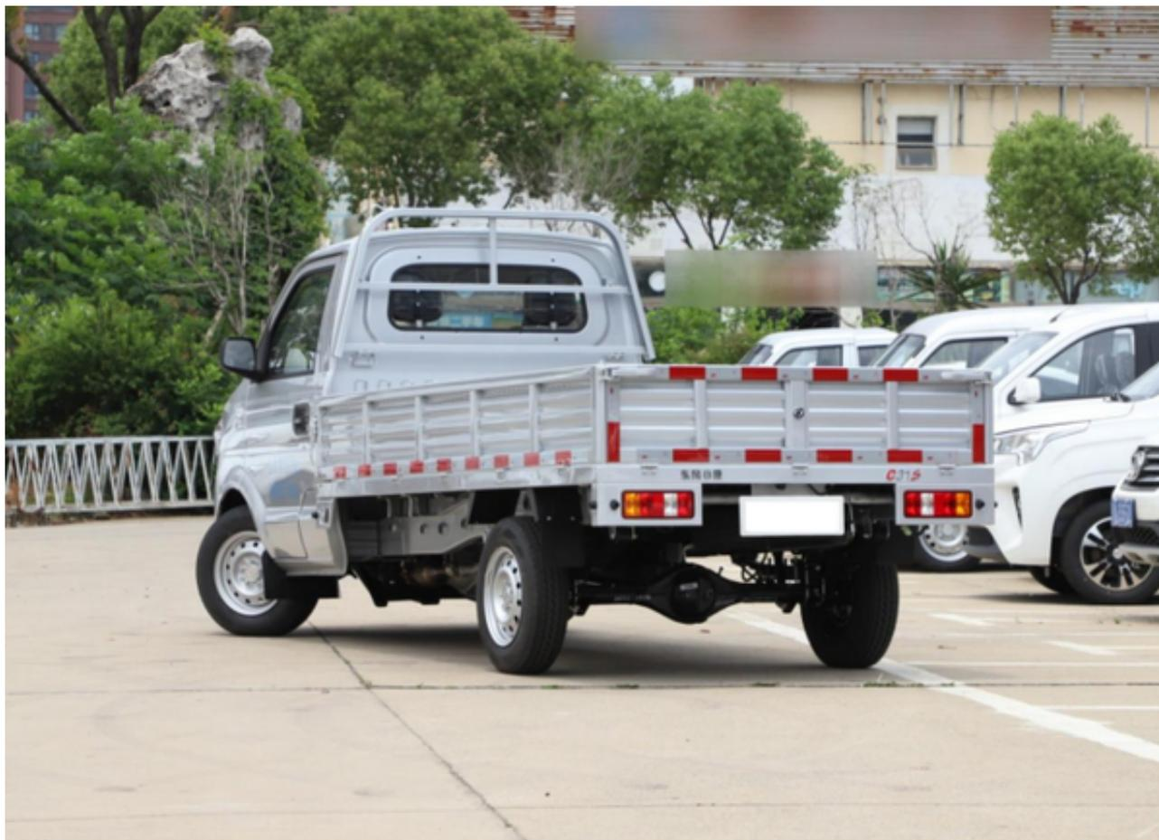
另外，由于东风小康C31S采用主副梁叠加结构，承载区加强横梁提高到9根，悬架采用6篇钢板弹簧设计，钢板厚度达5.5mm 通过70万次疲劳试验，使得整车的承载能提升90%，所以那些担心微型货车不适合用来装实木家具或家电的人，可以打消这方面的顾虑了。
