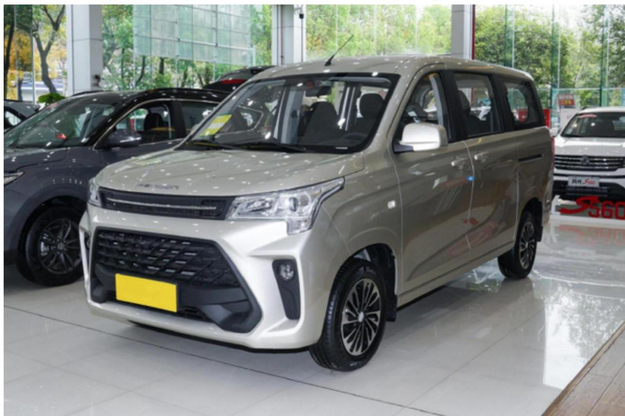
风光380在设计上并不是那种一眼廉价的商用工具车，四方的车身中既拥有立体的多段式腰线，也拥有车头的三区气孔。更重要的是，风光380拥有4610/1750/1860mm的长宽高与长达2850mm的轴距，配合前面提到的四方车身，它能够在同级少有的宽体结构下，实现出色的舱内乘储空间。
