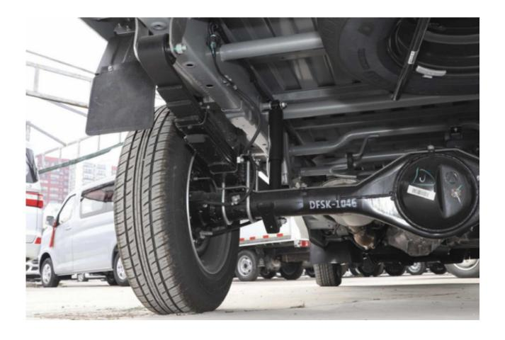
而且我们前面其实已经提到了东风小康C31S在结构性打造方面的用心,更多加强横梁与大厚度钢板弹簧的出现,使得车辆在面对路面冲击时,能够更好地确保结构上的安全与货物的稳定。除此之外,东风小康C31S的钢板弹簧悬架还采用了上置式设计,说白了就能够把离地间隙抬得更高,让其不光能够应对城市、高速铺装公路,更能上山下乡,实现多路况通行与运输。
