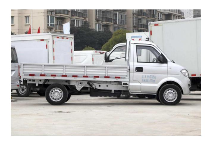
我们就按照1.6米的货物堆高来算吧,这台车的实际载货容积可以达到7.8m³,我们这样说吧,一台300L容积的冰箱体积大约在1m³以内,而这意味着东风小康C31S至少能装下8台家用冰箱,这承载能力可见一斑。而且还需要说明的是,通过采用6片钢板弹簧悬架、主副梁叠加结构以及9根加强横梁等高刚性设计,东风小康C31S能实现最大达1035kg的载重量,优势显著。
