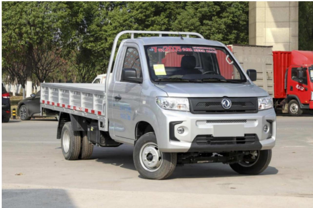
在同级别市场中，东风小康D71是凭借尺寸达到了领先位置，也占有了货卡最为关键的空间优势。5710/1785/2050mm的长宽高是一台实实在在的小卡的水平，也因此，车辆拥有了3.4米的超长宽阔货箱。
