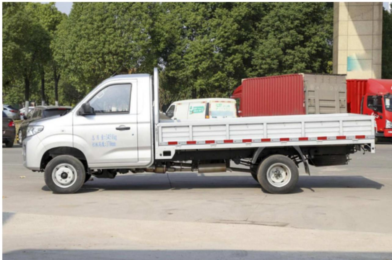
就是通过本身的长车身设计打造下的基础，除了储物体积宽阔、单体大货体积更大之外，车辆还依靠这样的大货箱、底盘悬架结构以及横梁结构中的强化打造，实现了高达1775公斤的载重量，这在同级别市场中也同样是独树一帜的。
