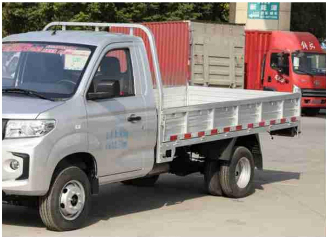
最后再来分析下动力，在搬运货物的时候车身自重也会大大提升，如果采用动力较小的发动机，不仅会增加用车成本，更会出现爬坡困难的尴尬情况，很影响我们拉货的效率和体验。东风小康D71配备1.6L发动机，最大功率122马力，最大扭矩158牛·米，对采用中置后驱设计的东风小康D71来说，这台1.6L已经能够实现满载时轻松爬坡了，拉货完全没压力。并且1.6L车型的综合油耗为7.2L/100km，用车成本也很低。东风小康D71还提供2.0L动力可选，这在同级车中就比较少见，可以满足更强的动力需求。
