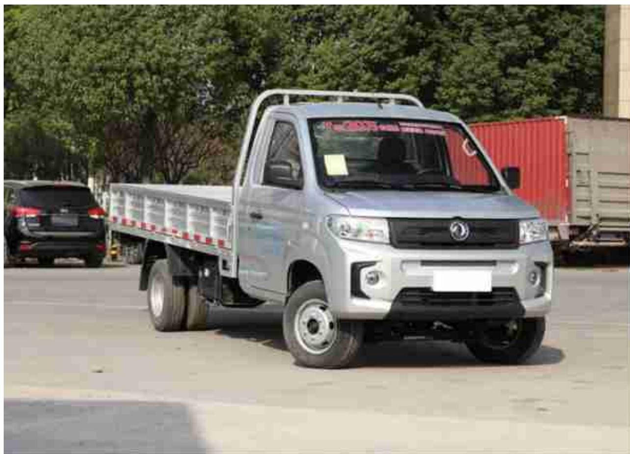
我们既然要选择一款小卡，最看中的肯定是小卡的承载能力，那么东风小康D71的承载能力如何?东风小康D71的车身长宽高分别为5710\*1785\*2050mm，轴距为3450mm。放眼去看诸多同级车，基本没有车长和轴距超过东风小康D71的车型。这样的设计能在保证货箱尺寸的同时，增加车内的驾乘空间以及车头前舱的安全距离
