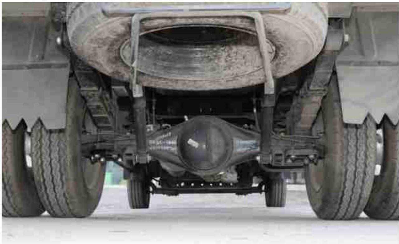
另外，东风小康D71还具备1487mm的前轮距以及1350mm的后轮距，加上本身3450mm的轴距，能让整车在空载或满载情况下，都能保持平稳的行驶表现。这是因为车辆的轴距越大、轮距越宽，在空载或满载时，车辆的行驶稳定性也会更高，对我们的出行安全和驾驶体验都有一定的优化作用。
