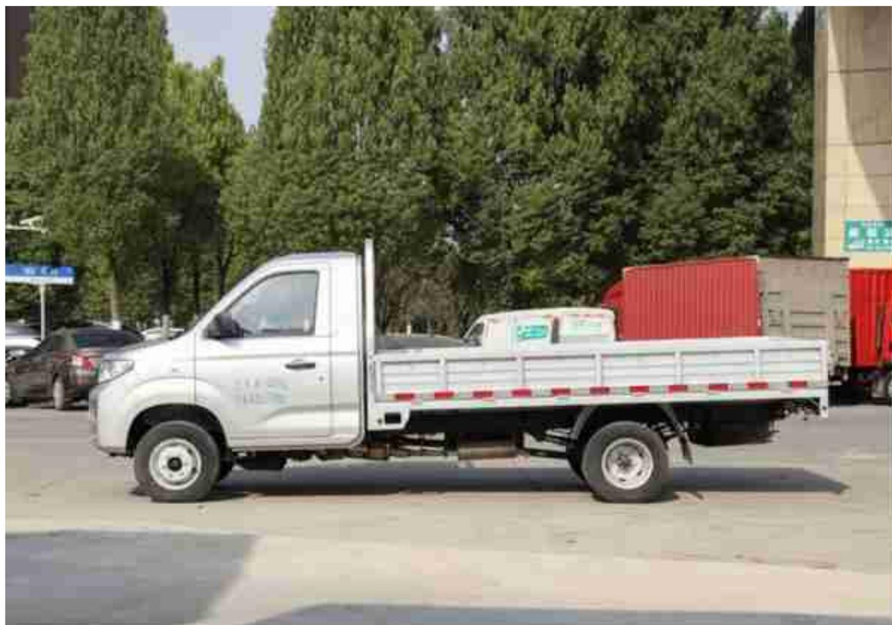
大尺寸车身也是大尺寸货箱的保障，既然东风小康D71车长优势大，那么货箱尺寸同样不会小。实际上，这款车的货箱长宽高分别为3400/1680/370mm，同样达到同级最大水准。在实际拉货过程中，无论是常见的箱装水果/饮料/零食，还是大尺寸的装修建材、亦或是如石狮子这般大尺寸的不规则物品，都能轻松装进东风小康D71的货箱内部。这对货运行业的帮助可不小，既能一次性装走更多货物，又能轻松放入其他车型不好装下的货物，增加拉货效率。
