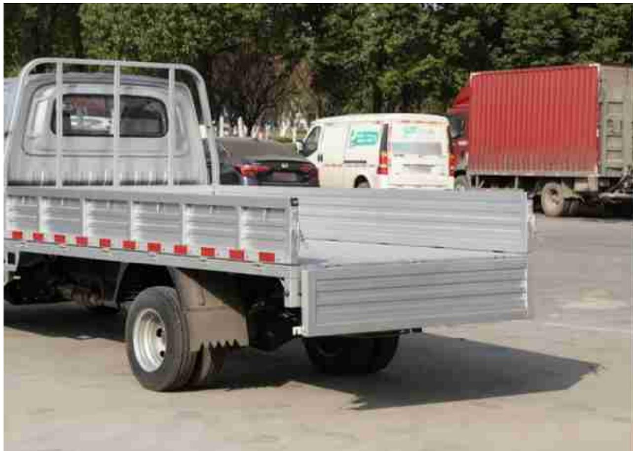
当然，判断承载能力不能只看装载空间，更得看载重能力。东风小康D71的最大载重质量可达1775kg，在我们日常生活中，大多数的城市物流运输场景中，都不需要运送超过2吨的货物，东风小康D71提供的载重量，已经能应对多种物流场景了，沉重货物也能拉。而能实现大载重，主要是东风小康D71全系均采用非承载式车身+双后轮+前后钢板弹簧悬架，通过多种方式提升车辆的载重能力。
