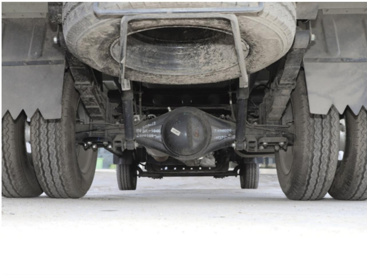
除此之外，东风小康D71采用了粗壮的大梁，它还采用了钢板弹簧的后悬架，整车做工非常的扎实，它的底盘就像是一个钢铁巨兽，为安全提供了很好的保障。
