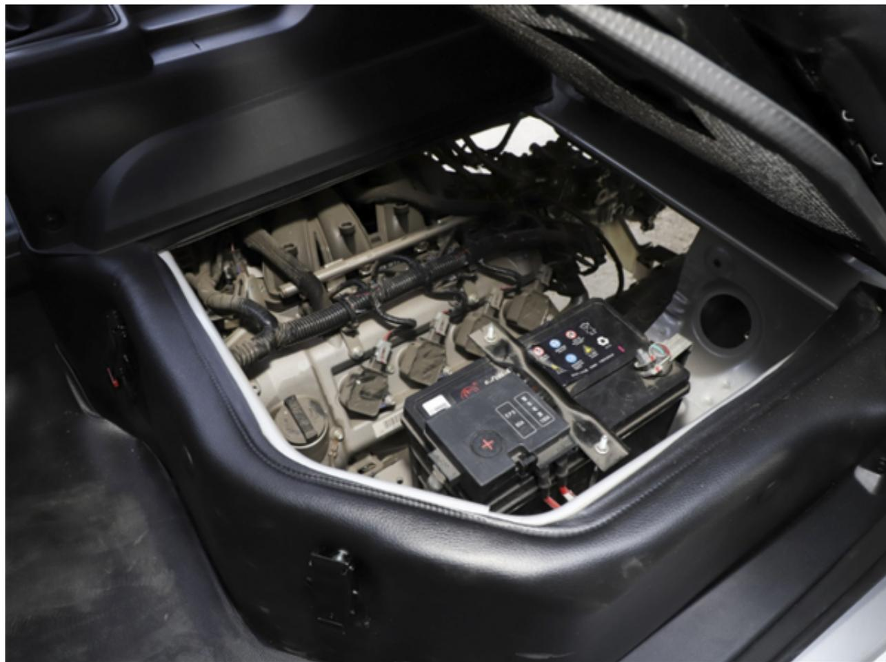
东风小康D71的2.0L自然吸气发动机，最大输出143马力，最大扭矩200牛·米，2.0L的动力在这个级别当中非常稀缺，并且它的价格明显不高。
