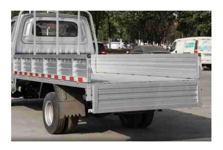
作为一款货运车,东风小康D71的装载能力自然不可忽视,而它也没让我们失望, 其具备越级的装载货箱,货箱长度达到了3400mm,货箱宽度1680mm,货箱宽度 370mm,最大载重质量为1775kg,比市面上其他四五万同类车型在载重能力上都 要领先不少。简言之,别的车送货可能需要跑两趟,它一趟就能装完,从而降低运 输成本,也就能让用户挣更多钱。
