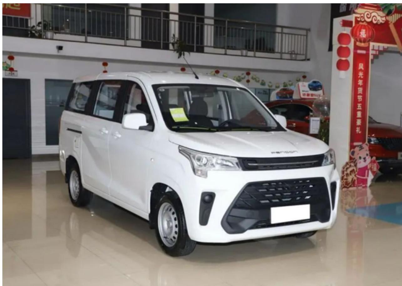
车身尺寸方面，风光380的长宽高分别为4610/1750/1860mm，轴距为2850mm。提供两座，五座，七座和八座等多种座椅布局，并且后排座椅能够放倒和拆卸，
