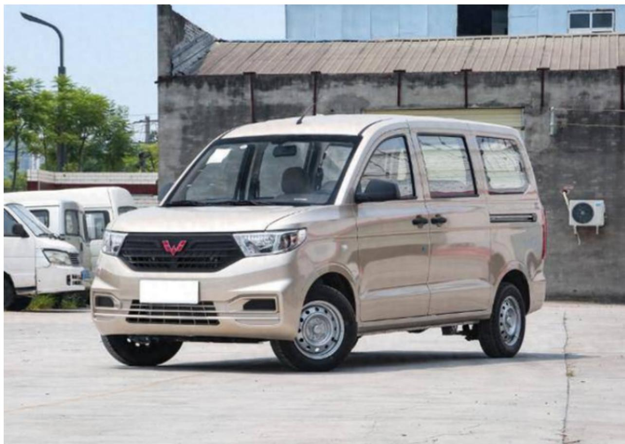
五菱宏光V的长宽高分别为4425/1670/1860mm，轴距为2850mm。同样提供两座，五座，七座和八座等多种座椅布局，后排也可以放倒和拆卸，但由于长度和宽度不及风光380，所以空间表现稍逊一筹。
