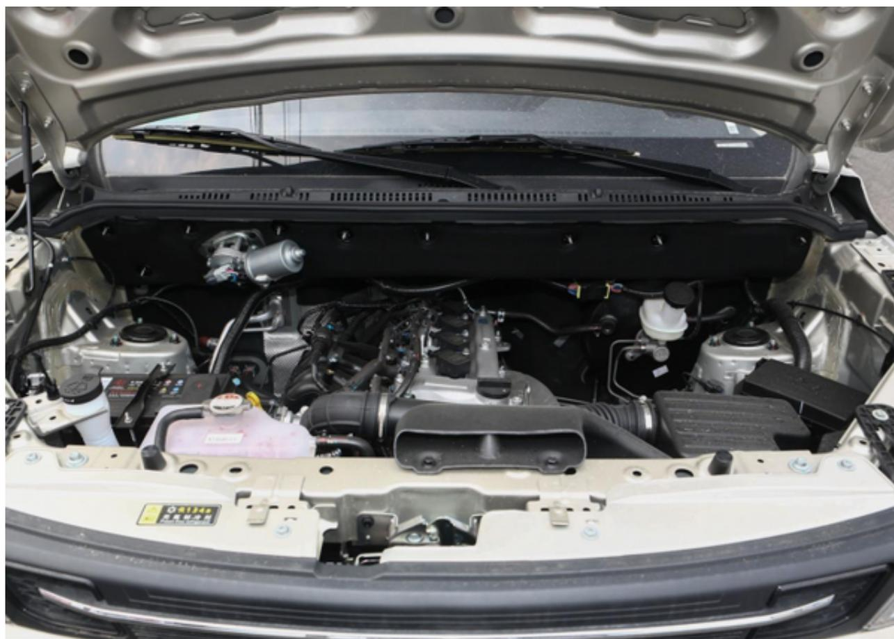
风光380提供1.5L动力系统，匹配5速手动变速箱，发动机最大功率112马力，峰值扭矩147牛·米。
