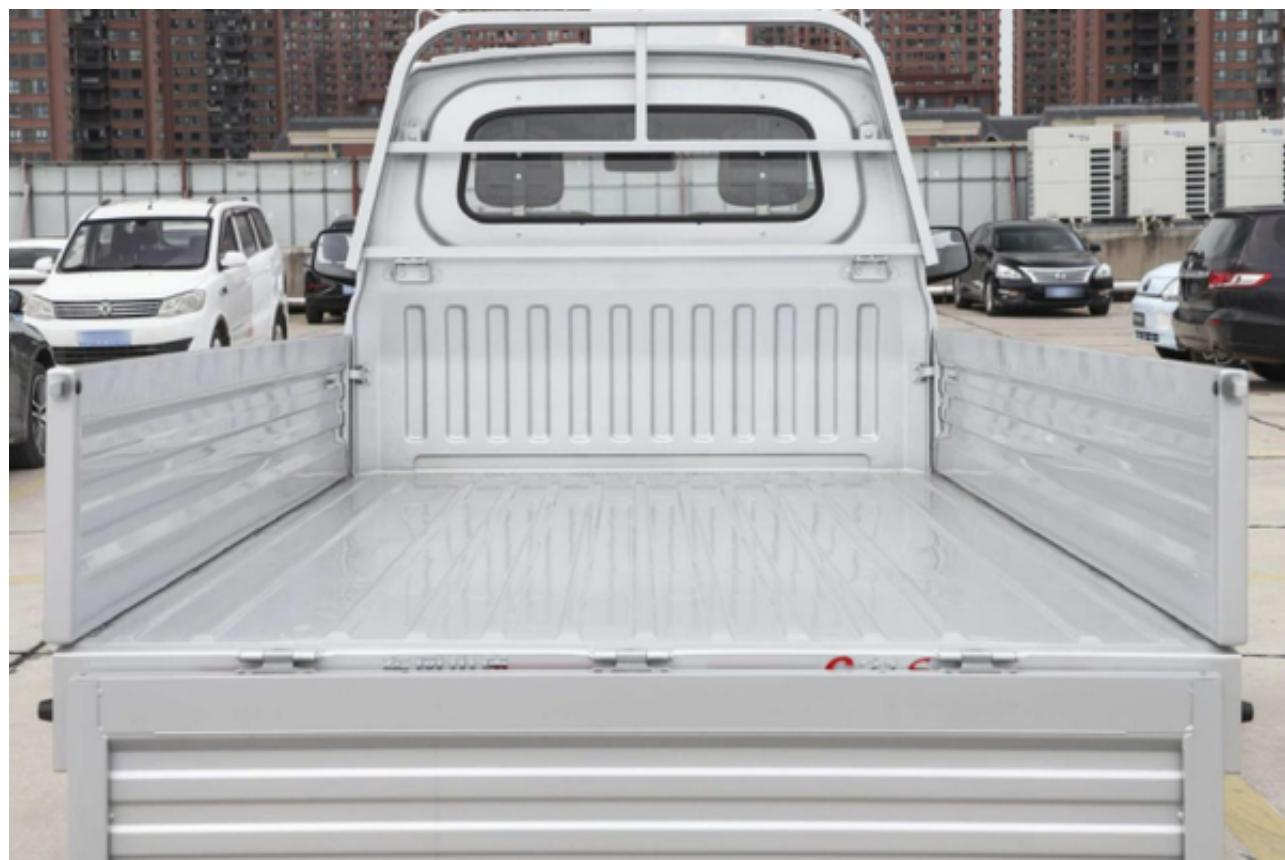
光只有大尺寸、大空间，这要是机械结构支撑不起来，不光承载能力会削弱，这安全性也会大打折扣。为此，东风小康C31S在完成了底盘与货箱支撑结构的强化，采用了主副梁叠加结构，并在核心承载区实现了9根加强横梁设计，配合底盘后桥中所使用的6片钢板弹簧设计，整体承载能力都得到了保障。
