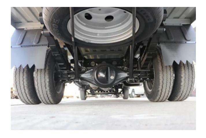
而在安全方面, 东风小康D71采用非承载式车身结构, 标配了双后轮, 增大了车辆与地面的接触面积, 减小了车重造成的压强, 不仅保证了车辆行驶过程中的稳定性, 也能满足用户多种载重能力和使用场景。
