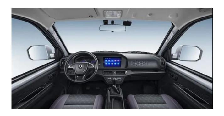
东风小康D71的驾驶室横向内宽度为1590mm,前纵向纵深960mm,前舱安全距离745mm,方向盘至座椅靠背的距离很宽,驾驶室内部的空间更大、整个座舱更加符合人机工程学,给用户带来更好的驾乘舒适性的同时还提升了驾乘安全性。
