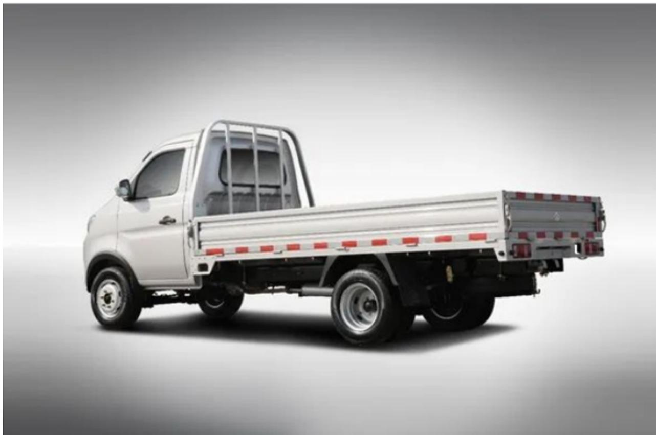
而长安跨越王X3的长宽高分别为5300mm×1780mm×2080mm，货箱尺寸为3200mm×1680mm×360mm，轴距为3190mm，通过尺寸数据对比，长安跨越王X3的货厢比东风小康D71小了很多，装载能力也就不及东风小康D71了。如果你运送同一批货物，东风小康D71只需要一趟就能拉完，而长安跨越王X3可能就需要两趟才能拉完，时间和油耗成本就比东风小康D71多出了1倍。
