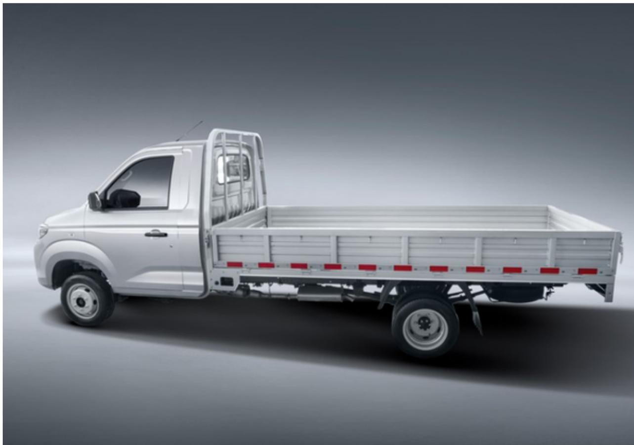
货厢越大，自然拉货能力就更强。东风小康D71的长宽高分别为5710mm×1785mm×2050mm，货箱尺寸为3400mm×1680mm×370mm，轴距为3450mm，最大载重质量1775kg，3.4m的超长超宽货厢让东风小康D71拥有了同级最大的载货空间。
