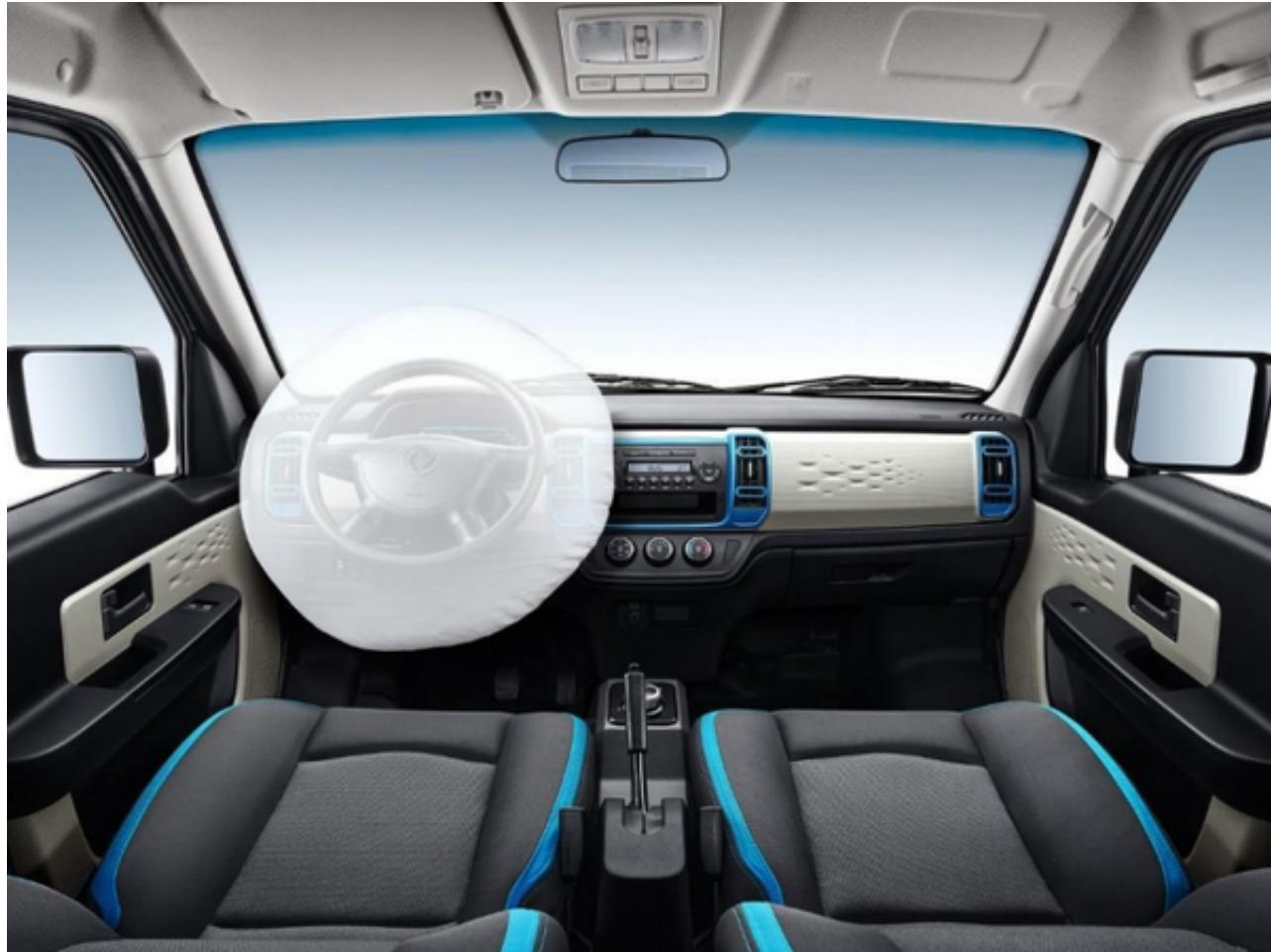
另外，东风小康EC36II的配置也是比较丰富的，像前排安全气囊、儿童座椅接口、后驻车雷达、倒车影像以及前排电动车窗等安全性和实用性功能都有配备，不仅提升了行车的安全性，驾驶便捷性也得到了相应的提升。
