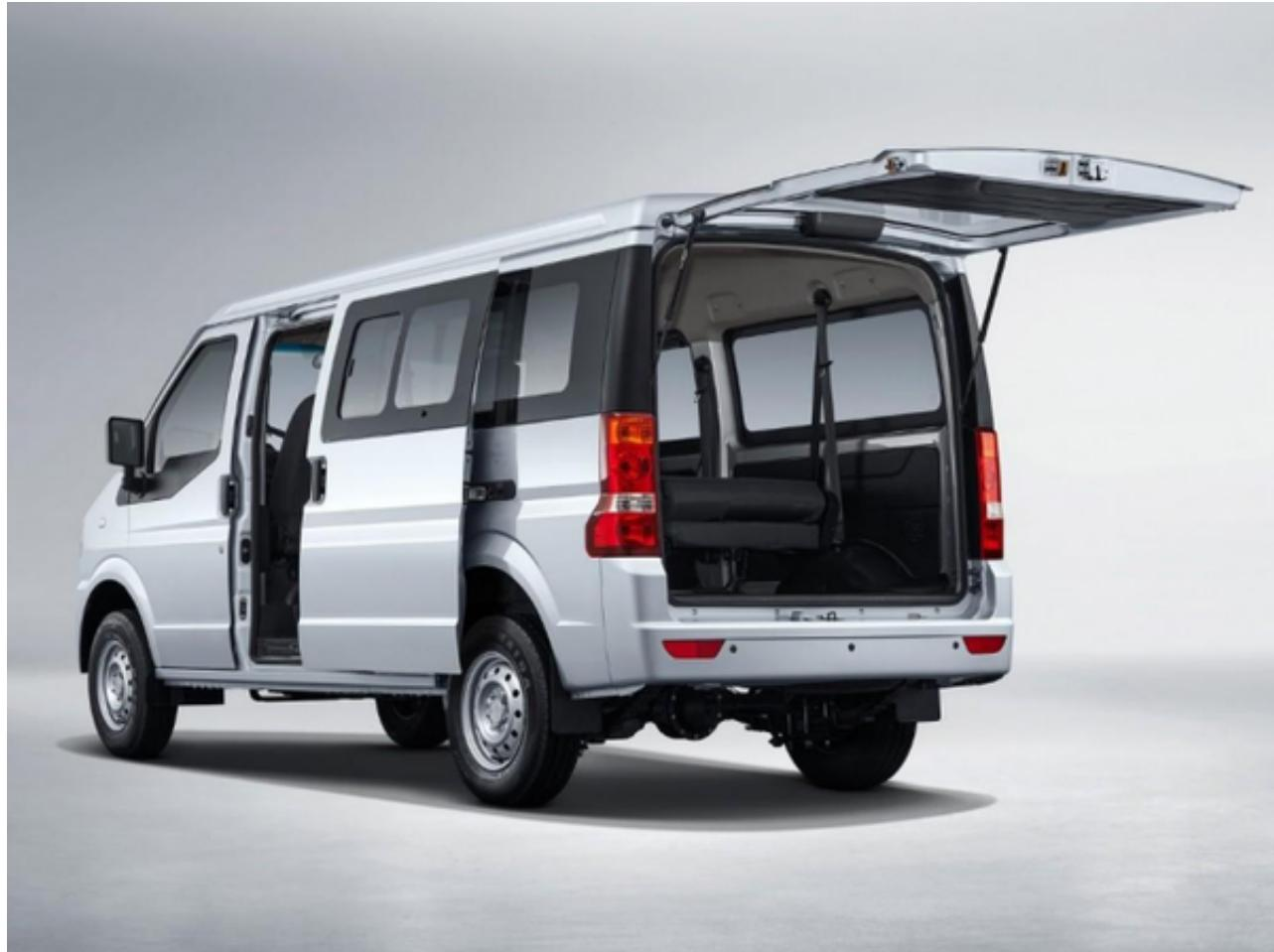
东风小康EC36II的长宽高分别为4500\*1680\*2000mm，轴距达到了3050mm，拥有 $5.1m^3$ 的超大车厢空间，这个尺寸在同级车型里算是比较优秀的，能够充分的满足用户对于装载能力的各种需求。另外，东风小康EC36II还有一个大开口的后备箱和较低的尾门门槛，可以方便大件货物的运输。无论你是超市进货，还是公司采购，又或者是自购接入拉货平台，这台车保证能够完成运输任务。
