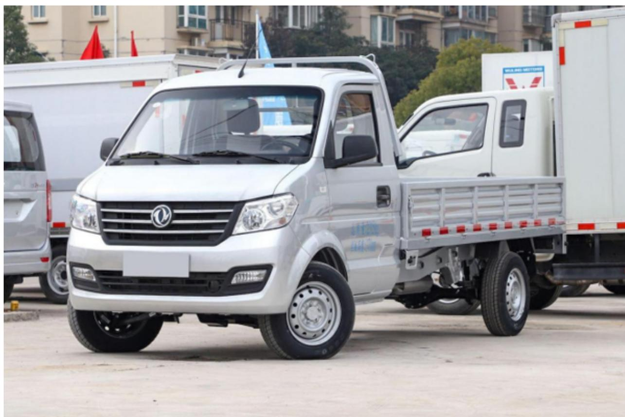
不管是什么类型的货车，只要涉及到“货”这件事，尺寸空间永远是第一位的。在这方面，东风小康C31S虽然定位在微货市场，但这4855/1670/1980mm的长宽高却是让同级别市场的竞争力望尘莫及的。更重要的是，在对于运输极为关键的货箱方面，东风小康C31S的长度已经来到了3200mm，比一般是3000mm水准的同级车货箱长度更出色。
