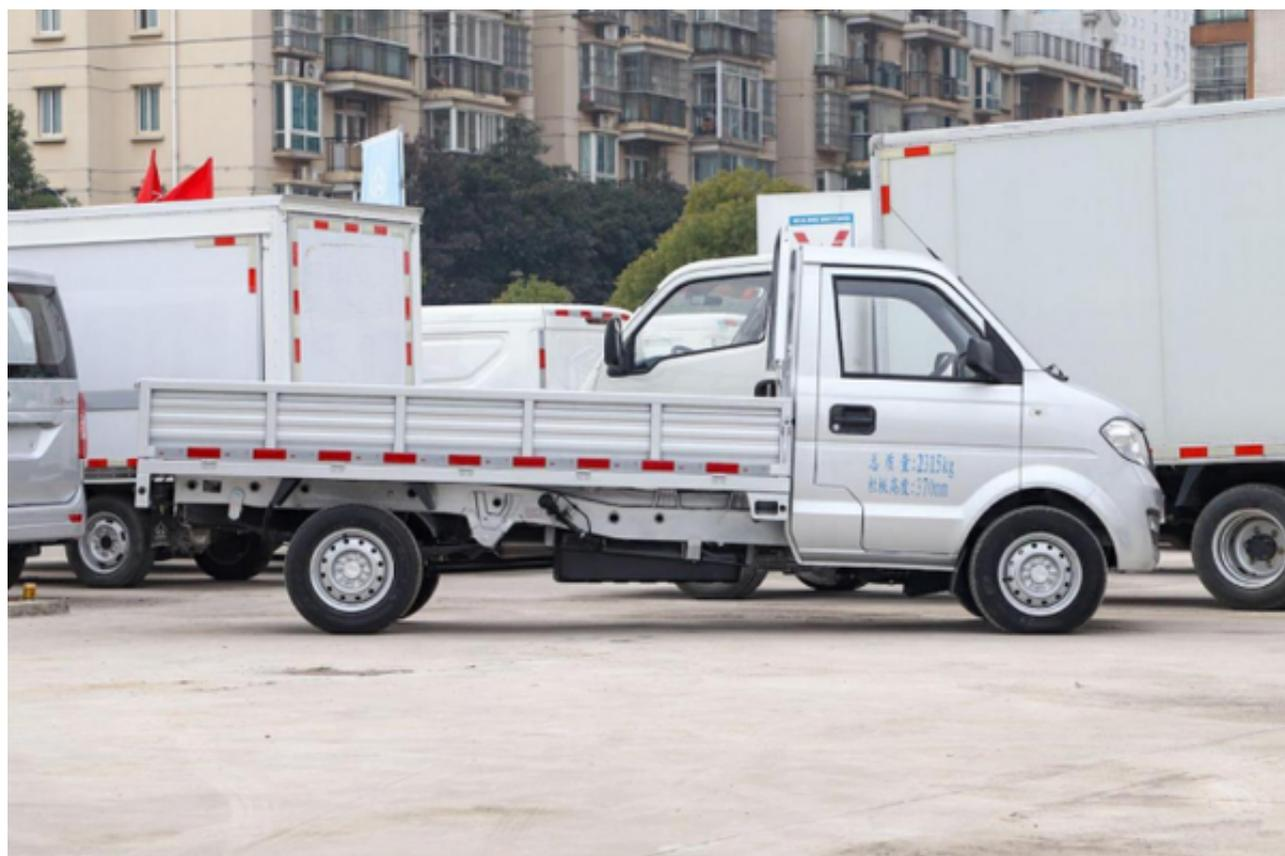
而正是这样的尺寸规格，为东风小康C31S带来了两项关键的核心优势，其一，东风小康C31S能够通过宽体结构实现更出色的横向支撑，减少车身摆动幅度的同时，也将让驾乘反馈更为舒适，也让货物更加“舒适”；其二，也是大车身带来的最直接的作用，就是为东风小康C31S创造了7.81m<sup>3</sup>的载货容积(以1.6米货物堆高来计算)，并实现1035kg的最大载重质量，这一数据是比直接竞争对手高出了足足290kg，不光是能装更大体积的货物，也能拉得动更大的重量。
