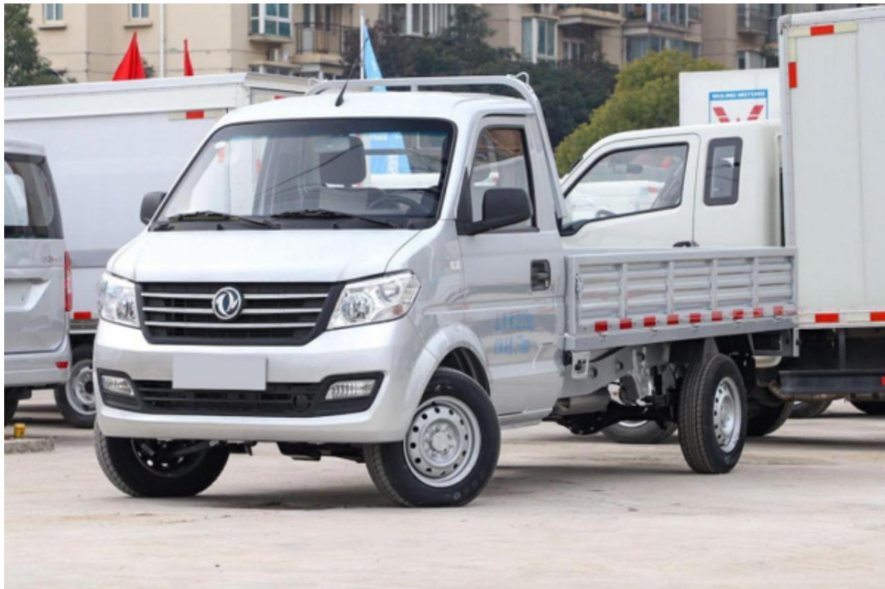
不管是什类型的货车，只要涉及到“货”这件事，尺寸空间永远是第一位的。在这方面，东风小康C31S虽然定位在微货市场，但这4855/1670/1980mm的长宽高却是让同级别市场的竞争力望尘莫及的。更重要的是，在对于运输极为关键的货箱方面，东风小康C31S的长度已经来到了3200mm，比一般是3000mm水准的同级车货箱长度更出色。
