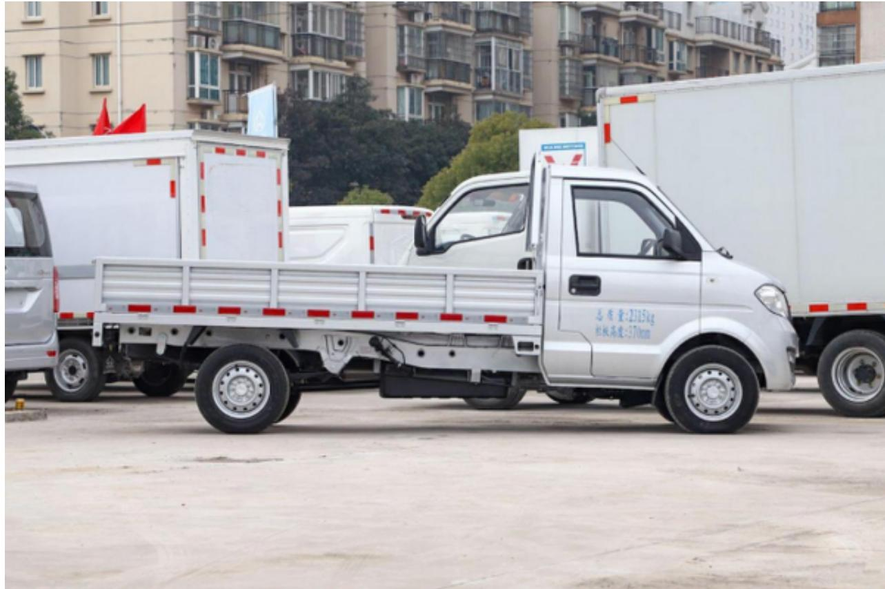
而正是这样的尺寸规格，为东风小康C31S带来了两项关键的核心优势，其一，东风小康C31S能够通过宽体结构实现更出色的横向支撑，减少车身摆动幅度的同时，也将让驾乘反馈更为舒适，也让货物更加“舒适”；其二，也是大车身带来的最直接的作用，就是为东风小康C31S创造了 $7.81m^3$ 的载货容积(以1.6米货物堆高来计算)，并实现1035kg的最大载重质量，这一数据是比直接竞争对手高出了足足290kg，不光是能装更大体积的货物，也能拉得动更大的重量。
