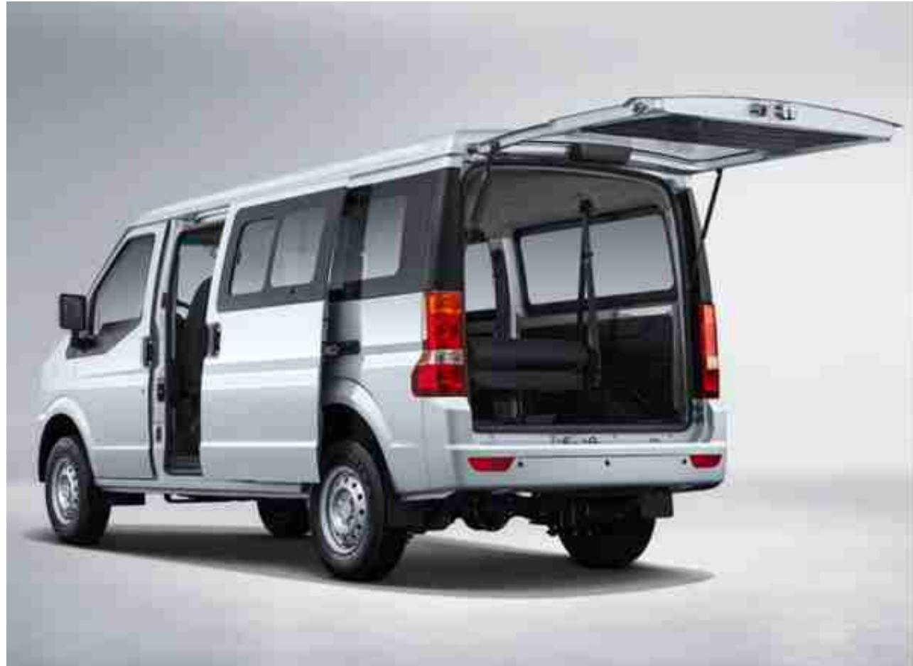
当然，对一款商用车来说，最重要的还得是车内空间表现。东风小康EC36II的车身三围分别为4500/1680/2000mm，轴距为3050mm，加上方方正正的车身轮廓，有效提升了车内的装载空间，整车的内部空间达到5.1m<sup>3</sup>，已经比很多尺寸更大的MPV车内空间大了。并且东风小康EC36II的后备箱开口也比较大，后备箱开启后和D柱形成90°左右的夹角，方便存放大件的货物到车内。
