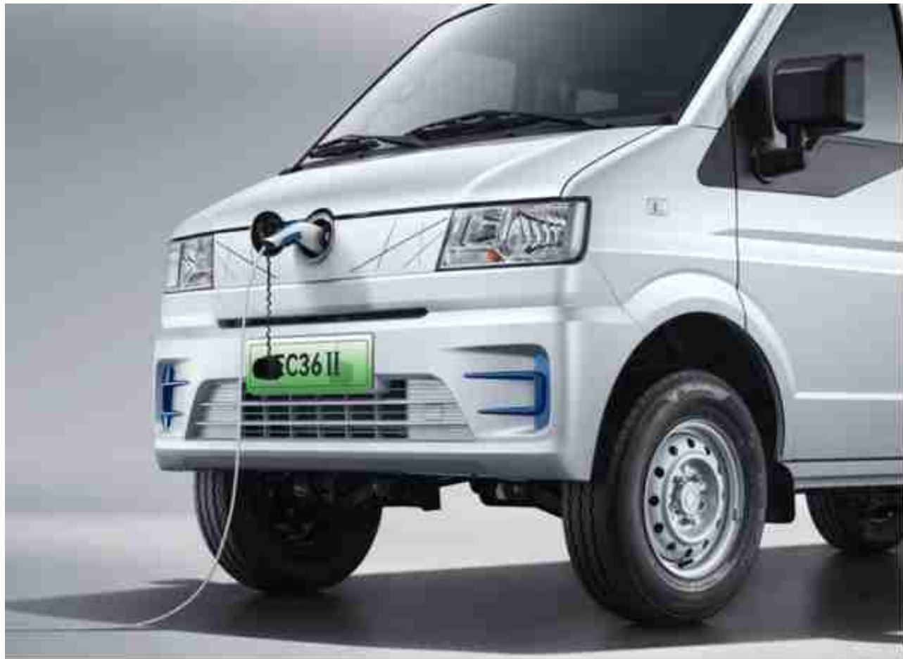
东风小康EC36II搭载磷酸铁锂电池，根据车型的不同，电池容量有38.64kWh和41.86kWh两种选择，分别对应252km和270km两种纯电续航。对日常拉货送货来说，这样的续航已经足够了，送货一天绰绰有余。并且在大城市中，快充电桩的普及度是比较高的，想要给东风小康EC36II补充续航也比较轻松。并且纯电动驱动有效降低了东风小康EC36II的日常用车成本，每公里出行仅需7分钱，哪怕一年行驶5万公里，用车成本也才3500元，相比普通运输用户综合预估3年可省超10万元，对比燃油车无疑要省钱不少。
