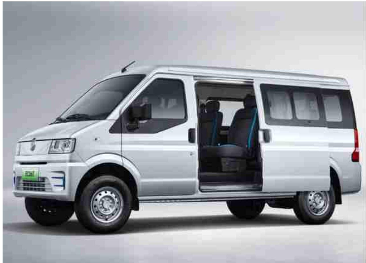
我们会考虑纯电动车，用车成本毫无疑问是一个关键性因素，尤其是对经常需要拉货送货的车主来说，高油耗带来的出行成本无疑会影响车主的最终收入。而东风小康EC36II搭载总功率为60千瓦、总扭矩200牛·米的电动机，后置后驱的结构保证了拉货送货过程中有充沛的动力，不至于动力疲软。
