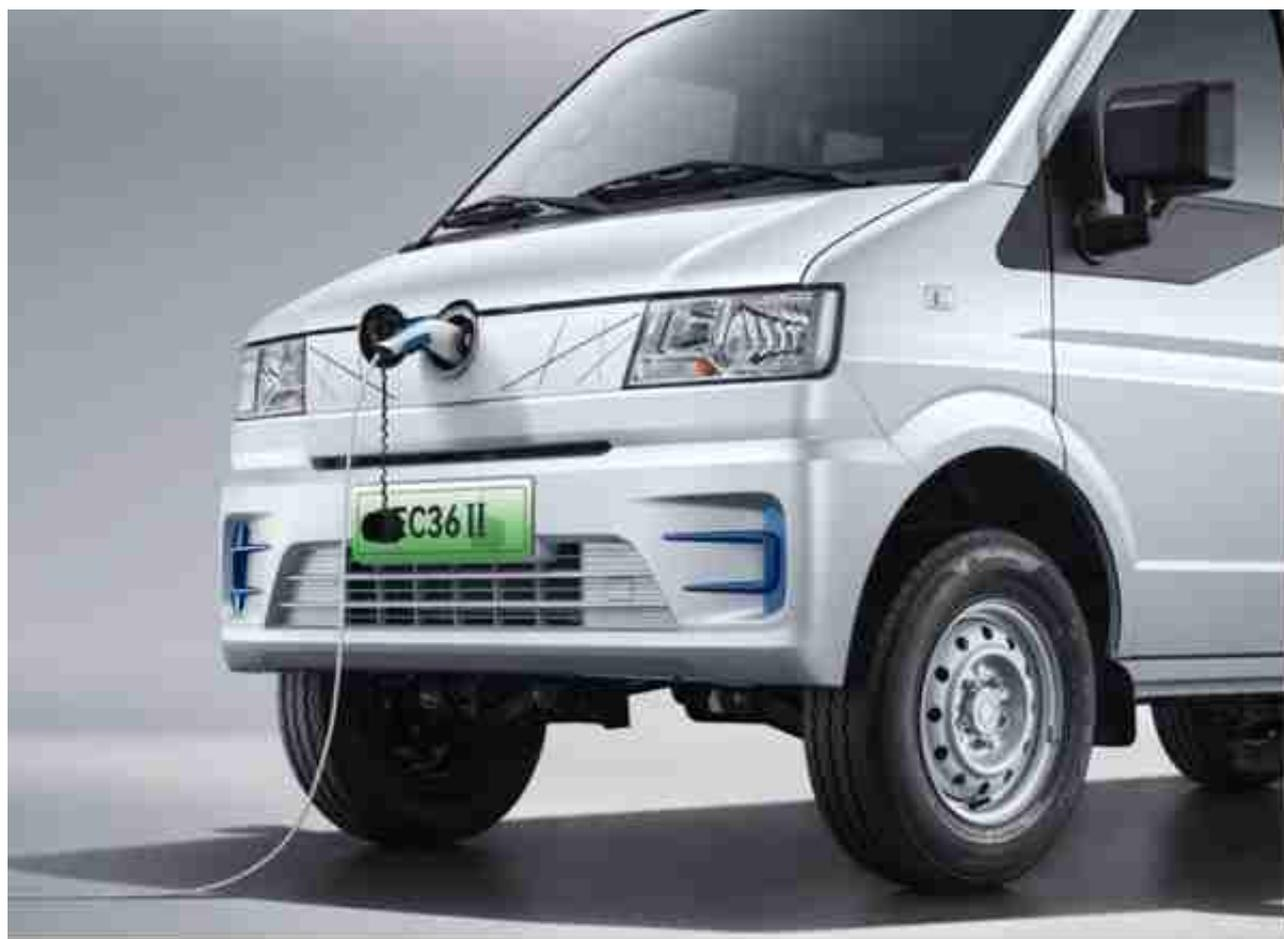
东风小康EC36II搭载磷酸铁锂电池，根据车型的不同，电池容量有38.64kWh和41.86kWh两种选择，分别对应252km和270km两种纯电续航。对日常拉货送货来说，这样的续航已经足够了，送货一天绰绰有余。并且在大城市中，快充电桩的普及度是比较高的，想要给东风小康EC36II补充续航也比较轻松。并且纯电驱动有效降低了东风小康EC36II的日常用车成本，每公里出行仅需7分钱，哪怕一年行驶5万公里，用车成本也才3500元，相比普通运输用户综合预估3年可省超10万元，对比燃油车无疑要省钱不少。
