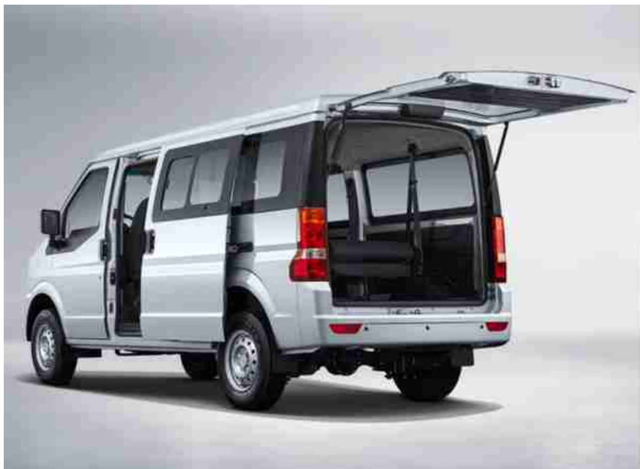
当然，对一款商用车来说，最重要的还得是车内空间表现。东风小康EC36II的车身三围分别为4500/1680/2000mm，轴距为3050mm，加上方方正正的车身轮廓，有效提升了车内的装载空间，整车的内部空间达到5.1 $\text{m}^3$ ，已经比很多尺寸更大的MPV车内空间大了。并且东风小康EC36II的后备箱开口也比较大，后备箱开启后和D柱形成90°左右的夹角，方便存放大件的货物到车内。
