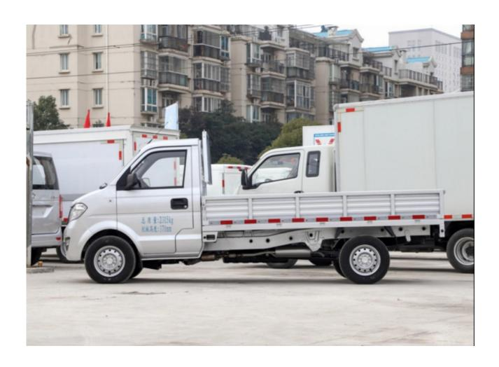
五菱荣光小卡外形尺寸为4535\*1595\*1870mm,轴距为3050mm,其货箱尺寸为2710\*1520\*320mm,而且五菱荣光小卡的载货量为745kg,货箱体积为6.59m³,前轮距为1378mm,后轮距为1408mm。
