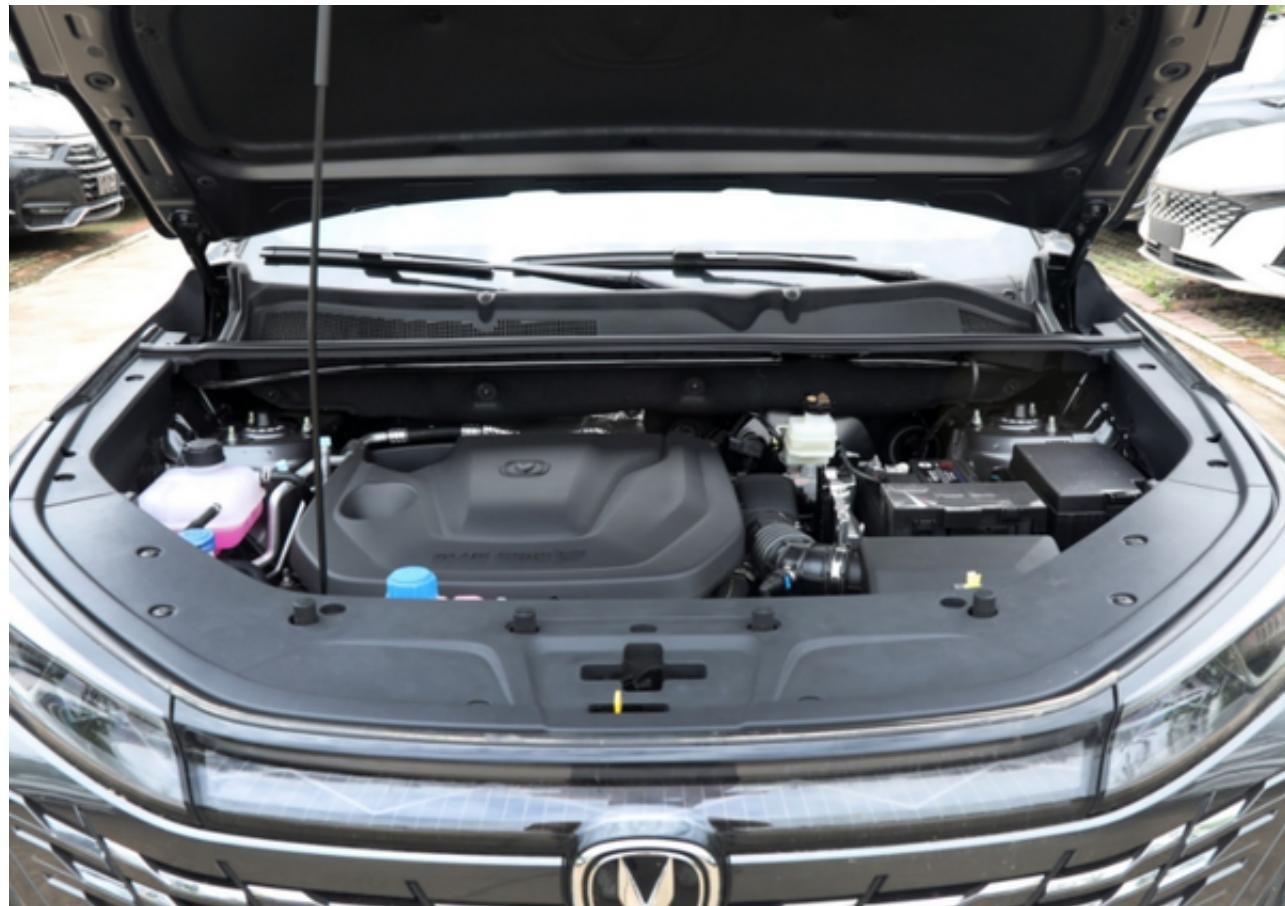
而蓝电E5采用1.5L+单电机组成的插电式混动系统，其中内燃机输出81千瓦功率和135牛米扭矩，单电机额外提供130千瓦功率和300牛米扭矩，0-50km/h加速2.9秒，零百加速仅需7.4秒，WLTC综合油耗低至1.23L/100km，馈电油耗低至5.4L。
