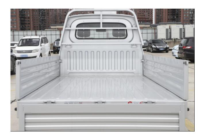
作为一款货运微货,它的装载能力自然不能忽视,基于领先同级别的车身尺寸,东风小康C31S在载货能力方面的也有不俗的表现,首先它货箱长度达到了2.9米,宽度达到了1.54米,它的装载容积达到了7.2m³,的确要比同级别其他微货装的更多,越能装代表着更能省。试想一下,如果一批货物,对于其他微货来讲,如果只跑一趟那就超载了,只能多跑一趟,而东风小康C31S直接一趟就给拉完了,这不就省下了一趟的成本吗?
