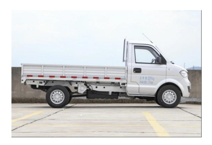
除了能让购车压力减小之外,东风小康C31S在实际用车过程中也表现出了领先同级别其他车型的一面。比如它的轴距、车身、轮距都达到了同级别之最,具体来看,它的车身尺寸为4730\*1655\*1960mm,车身尺寸越大意味着一次性能装载更多的货物,并且它的轴距达到了3050mm,轮距达到了1410/1410mm,整车的操控性更强,虽然对于微货来讲,用操控性来形容它不太合适。
