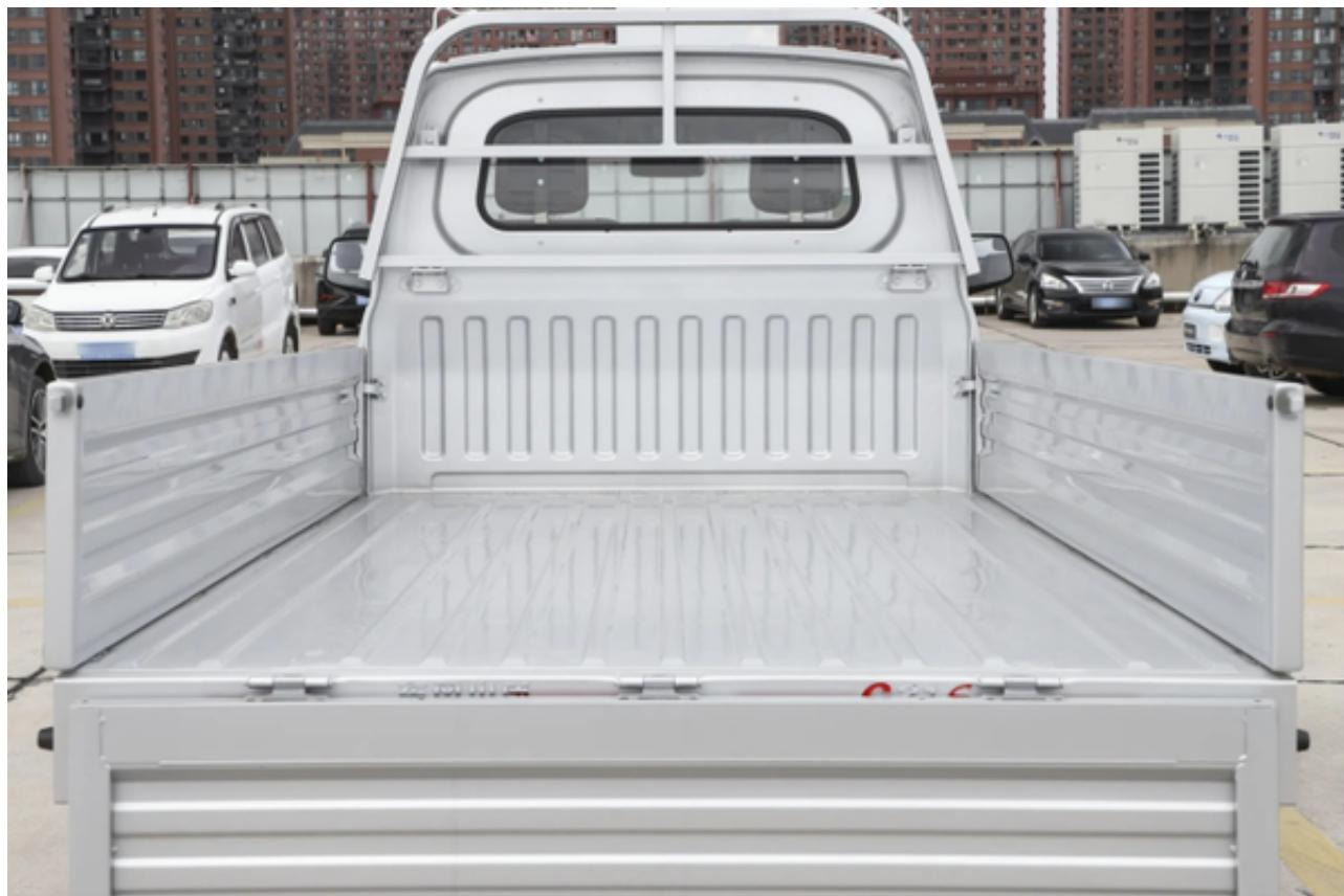
作为一款货运微货，它的装载能力自然不能忽视，基于领先同级别的车身尺寸，东风小康C31S在载货能力方面的也有不俗的表现，首先它货箱长度达到了2.9米，宽度达到了1.54米，它的装载容积达到了 $7.2m^3$ ，的确要比同级别其他微货装的更多，越能装代表着更能省。试想一下，如果一批货物，对于其他微货来讲，如果只跑一趟那就超载了，只能多跑一趟，而东风小康C31S直接一趟就给拉完了，这不就省下了一趟的成本吗？
