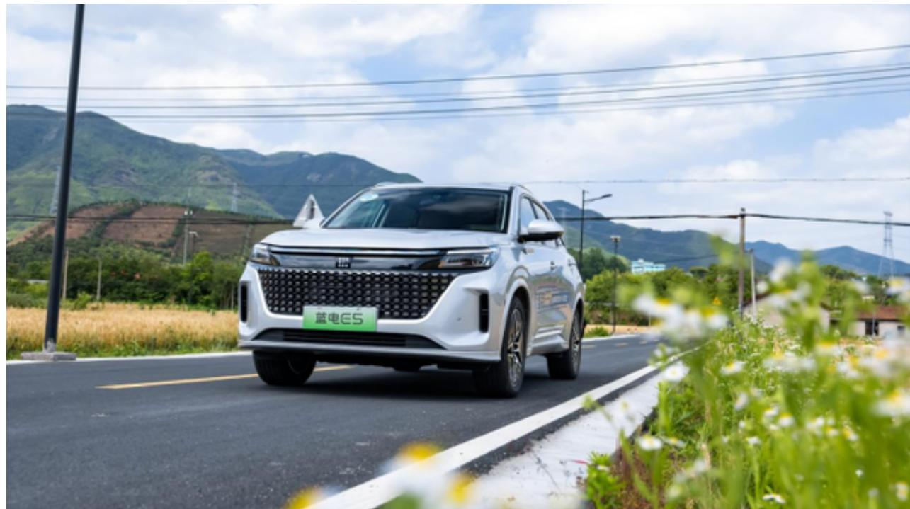
作为一款插混SUV，蓝电E5搭载了与比亚迪宋PLUS DM-i等畅销车型同源的弗迪动力插混系统，发动机和驱动电机分别有着81/130千瓦的总功率，以及135/300牛·米的总扭矩，0-50km/h的加速时间为2.91s，加速体验还是相当出色的。倘若你开着蓝电E5出行，正好道路的右边是一辆慢车，你一脚油门车子立马就窜了出去，这种随踩随有的加速体验可不是每一台SUV都能给予的。
