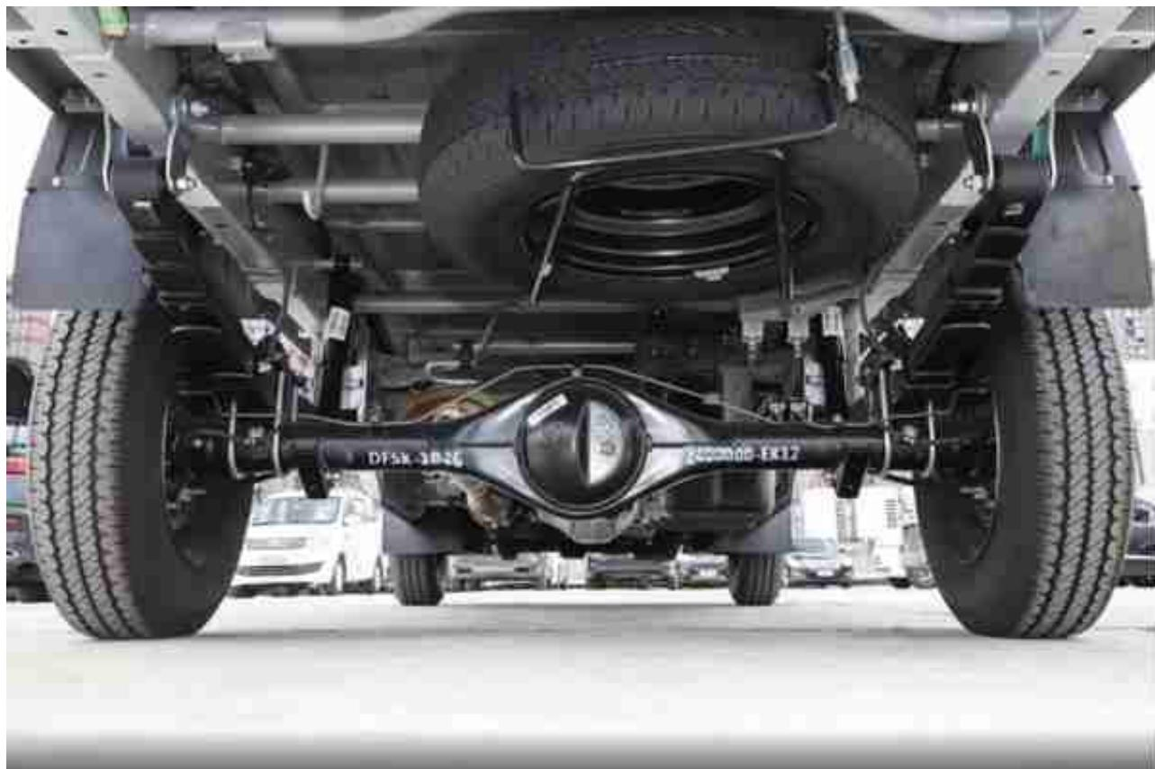
底盘方面，在同级长轴距、宽轮距加持下，东风小康C31S行驶起来更加稳定，在经过不平整路面时，车身起伏幅度明显比同级车型更小，也能够保证更舒适的操控性。同时它采用上置式设计钢板弹簧悬架，提高了车辆的离地间隙，也能带来更佳通过性。得益于长车头，在装载大量货物时，东风小康C31S也能杜绝“翘头”现象，意外发生的缓冲区域也足够宽泛，提升了整车安全性。
