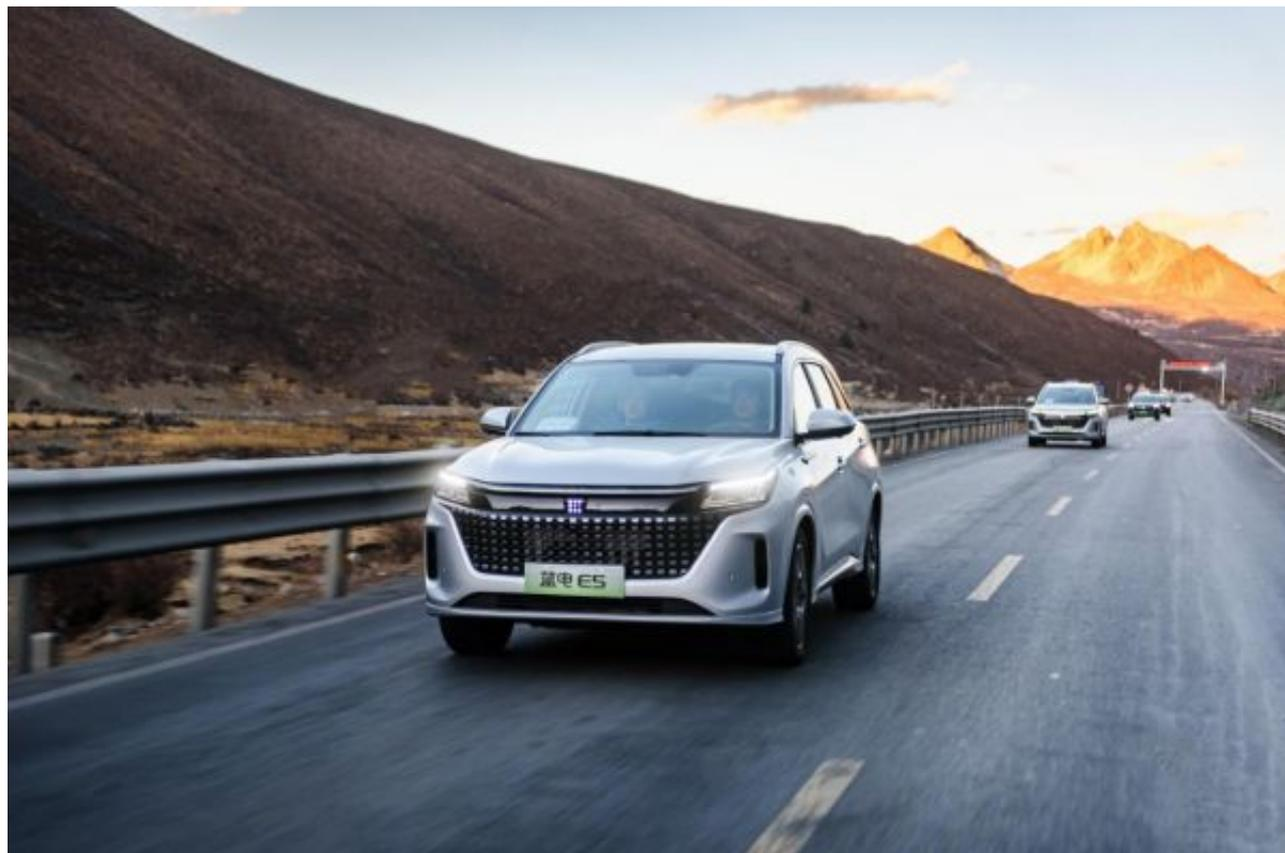
蓝电E5搭载弗迪动力的1.5L插混专用发动机，配备容量17.52kW·h的电池包，NEDC纯电续航里程达到100km，0-50km/h起步加速只需2.91秒。此外，蓝电E5的动力输出十分平顺，发动机介入时，体感上也并不会察觉得到。
