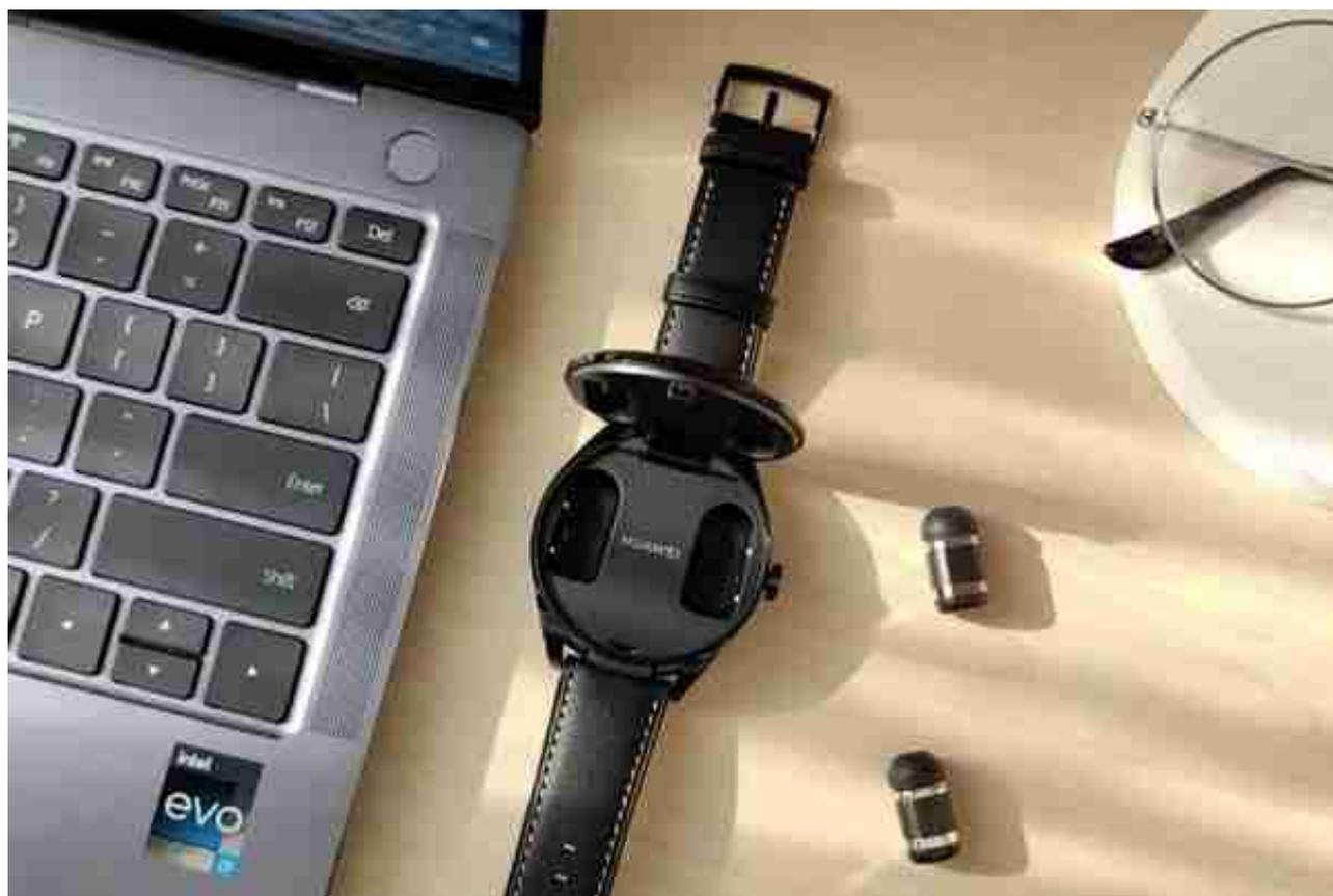
这也是得益于华为WATCH Buds采用了高集成技术及定制小型化精密器件，将一款小巧的真无线耳机放入智能手表。其中单耳的重量仅有4g，在封装技术上采用30微米的高精度自动定位密封技术，整体体积相比较传统TWS耳机体积减少了50%，内部的空间利用率达到了90%。而且耳机支持360°回盒充电，任意角度放到手表电池仓内皆可回盒充电，充电15分钟即可听歌一个半小时；不得不说华为这次的创新除了体现在形态上，更是在工艺和技术上取得了不小的突破。
