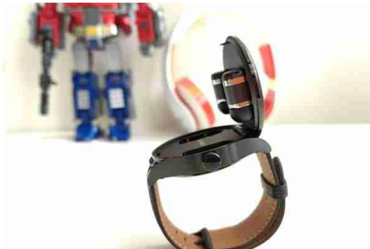
另外，细心的朋友可能会说，华为WATCH Buds耳机这么小巧，会有足够的空间进行触控操作吗？经过实测体验，我发现华为WATCH Buds与华为其他耳机产品的操控模式会有不同，搭载了加速度传感器，配合华为自研AI算法和人耳敲击大数据扩充，在耳机、耳廓或靠近耳屏的脸颊区域都可操控，范围更广、识别更准确，大幅提升整体算法性能并降低了误触率，比如，双击可接挂电话、播放/暂停音乐，三击可开关降噪功能，还支持操作自定义，多种功能触耳即达。在早晚高峰地铁上，只需敲敲耳机，相关指令即可轻松实现。
