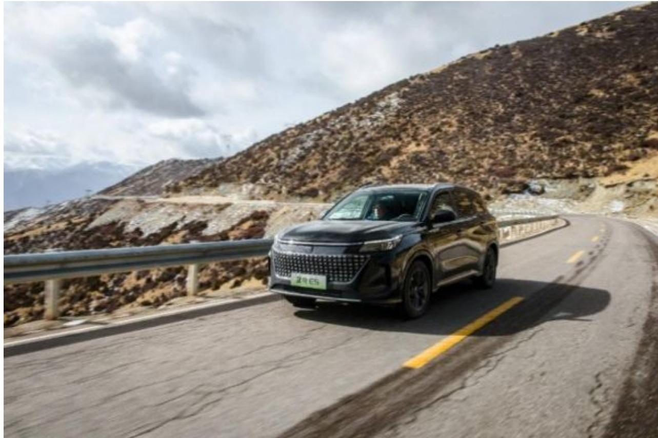
在蓝电的工程师团队精心调校下，蓝电E5的动力表现也很优秀，发动机最大输出功率为110马力，这套发动机采用阿特金森循环，有行业顶级的热效率，使得蓝电E5节油性能较为出色，馈电油耗仅5.4L/百公里。它的电动机最大输出功率为177马力，最大扭矩为300牛·米。蓝电E5的起步采用的是电机驱动，所以瞬间爆发的300扭力推背感明显，0-50km/h只需2.91秒，高速再加速的状态下，它的电机和发动机可以共同驱动车辆，即使在高速状态下依旧可以有明显的推背效果，超车很从容。
