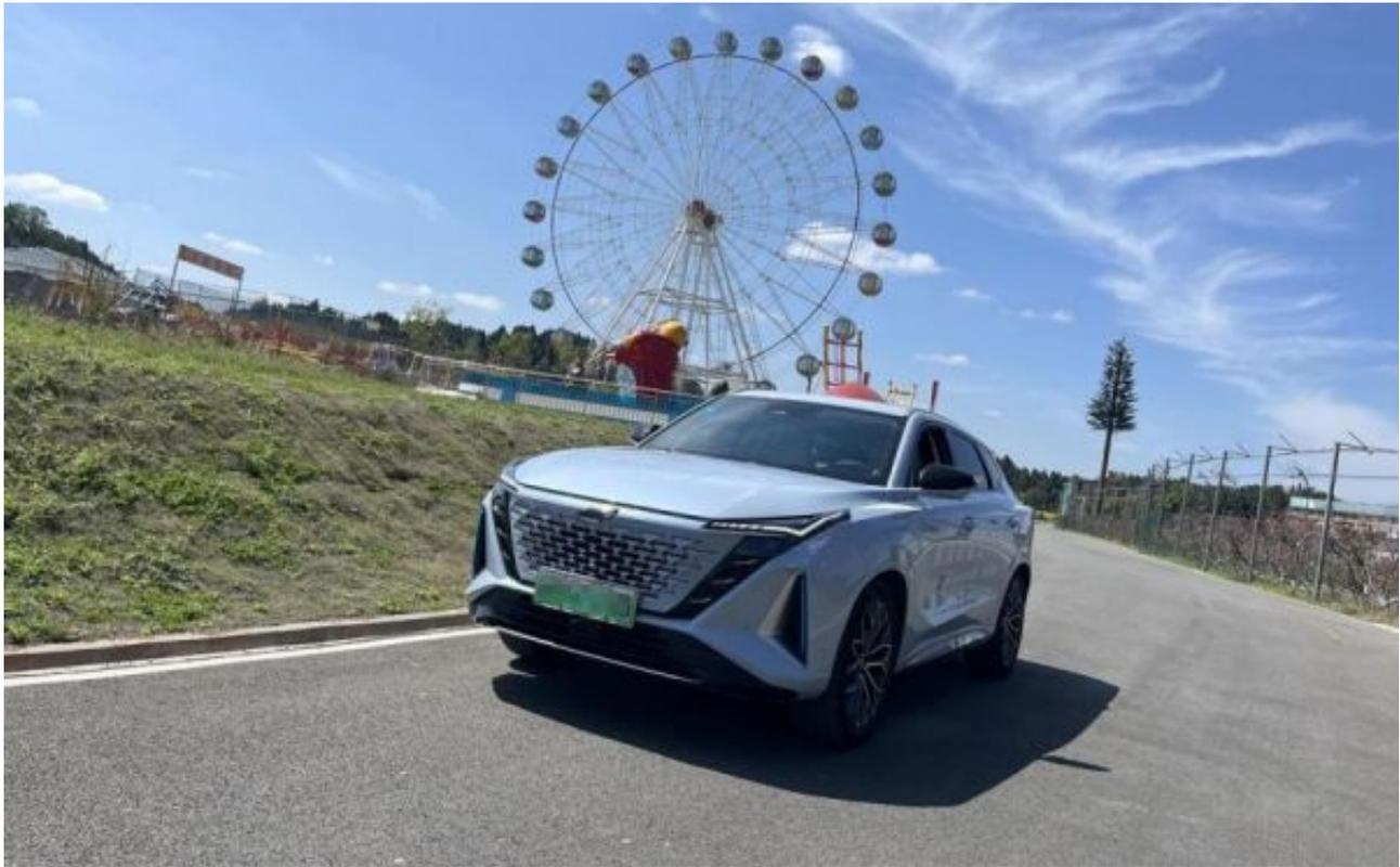
欧尚Z6 iDD搭载了蓝鲸iDD特级混动系统，由1.5T涡轮增压发动机和电动机组成，因为它也采用电机起步，起步加速也很猛，后期的提速也很快。整体来说，它的发动机基础动力很大，但在油耗方面表现就逊色不少。与弗迪动力混动系统不同的是，长安欧尚Z6 iDD还是采用老旧的P2插混架构，这套架构目前在市场上属于较落后的技术，不仅在驾驶方面顿挫感强，电动驾享感差强人意，油耗高、噪音大也是被市场诟病的主要问题，大部分车企都已经放弃了这种架构，就连长安自己也意识到问题并正在逐渐抛弃，转头向着p1+p3的串并联方案的方向走。
