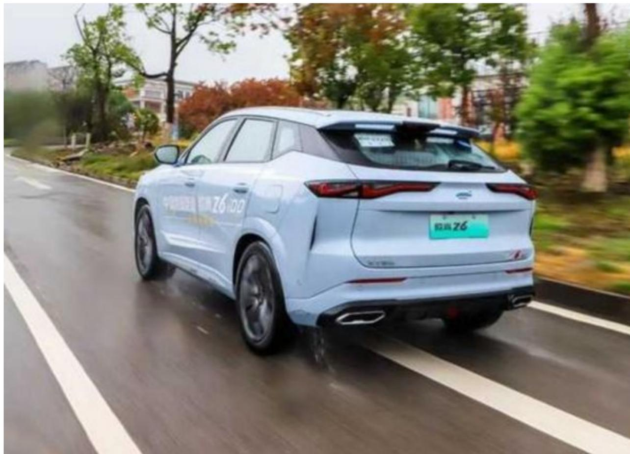
再来看看欧尚Z6 iDD，它搭载了蓝鲸iDD超级混动系统，并使用了1.5T涡轮增压发动机和6档三离合电驱变速器。这套混动系统使用了P2的混动架构，它有着成本低廉的优势，但由于技术较为落后，算是被长安抛弃的混动技术，远不如长安目前主流的P1+P3技术路线，因此无法应对车辆的速度波动，日常使用的体验感较差。
