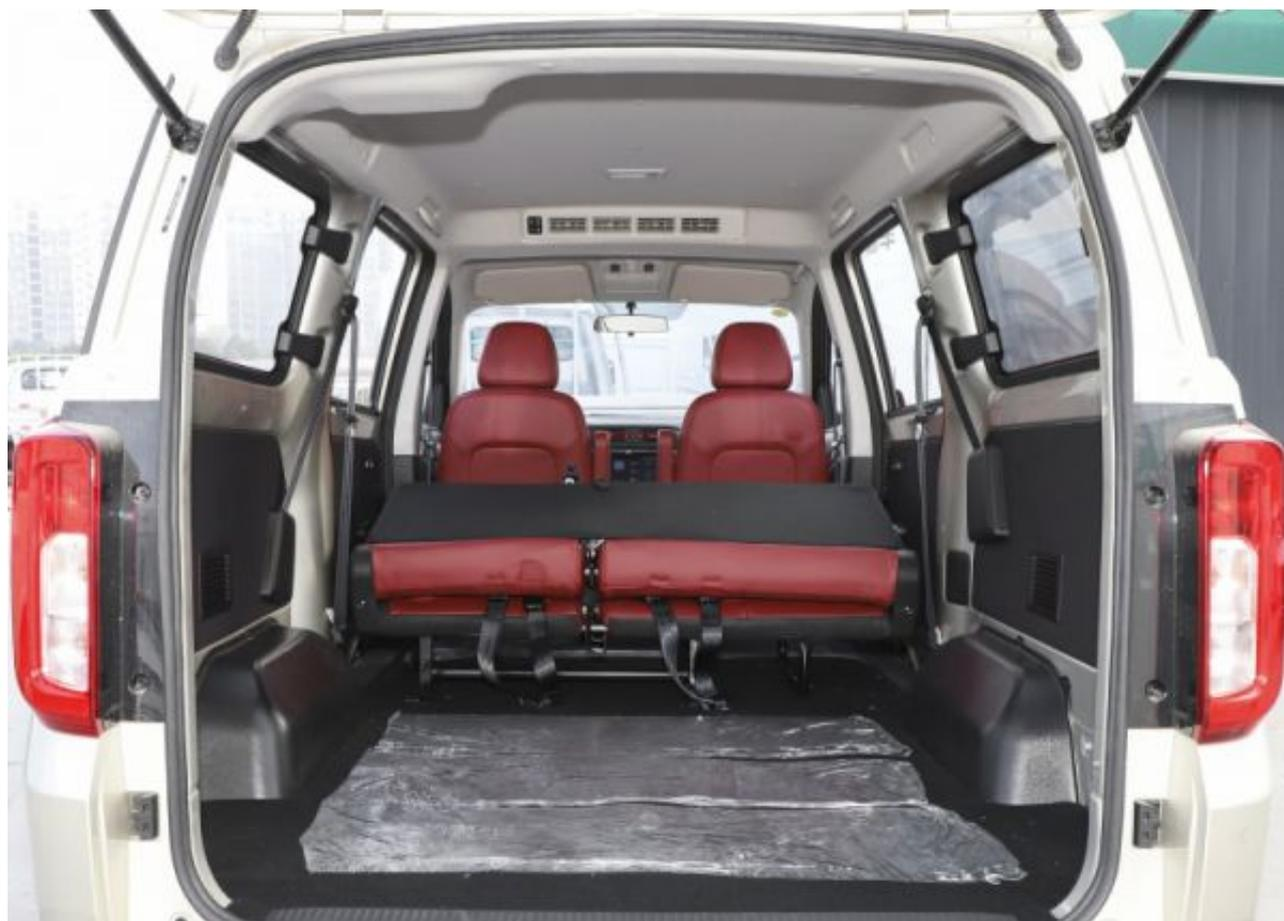
再来看看载人，风光380能够提供两座，五座，七座和八座等多种座椅布局，而且后排座椅能够放倒和拆卸，不仅能够装满一车的货物，也能同时载物坐人，并且7座车型的第二排为两个带扶手的独立座椅，大大提升了微面的乘坐舒适性。
